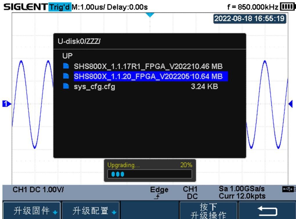
5. 进度条加载完成后会出现如下图的提示，按前面板电源键进行关机，再按电源键开启，完成升级：
