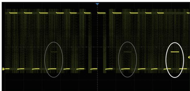
正常模式下 20 万帧 / 秒，Sequence 模式下 50 万帧 / 秒的波形刷新率，使示波器能快速捕获到低概率异常事件
