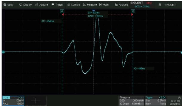
每通道最大 4 Gpts 的波形存储空间，最大采样率下，可播放 800 ms 时间的波形，无需牺牲信号带宽，满足复杂场景测试需求。
