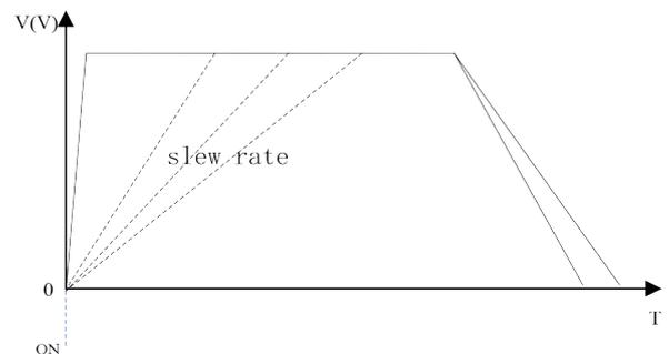
可调输出电压电流上升 / 下降斜率
