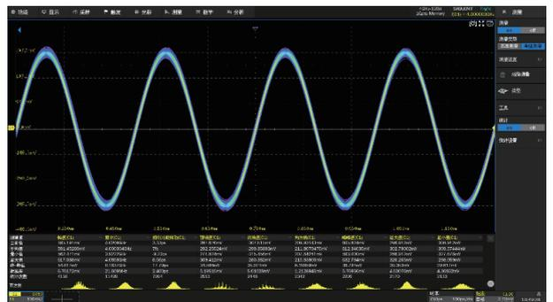
参数统计功能可显示任意参数的五种测量值：当前值、平均值、最小值、最大值、标准差；可同时测量统计 12 种不同的参数。直方图统计可以直观地显示参数的概率分布情况；趋势图和轨迹图可反应参数随时间的变化规律。
