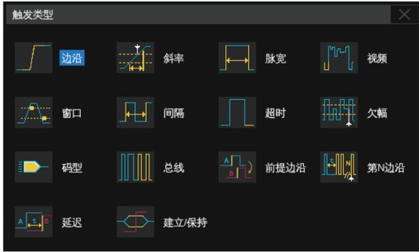
具有丰富的触发功能,包括边沿、斜率、脉宽、视频、窗口、间隔、超时、欠幅、码型、延迟、前提边沿、第 N 边沿、建立保持和多种总线触发(串行触发)
