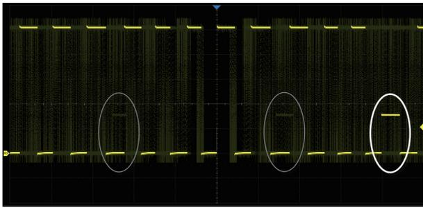
正常模式下 170 000 帧 / 秒，Sequence 模式下 750 000 帧 / 秒的波形刷新率，使示波器能轻松捕获到低概率异常事件
