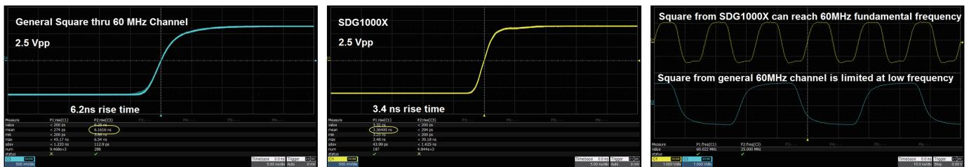
得益于专门的方波产生电路，SDG1000X 产生的方波打破了 60 MHz 的通道带宽限制，其输出频率可达 60 MHz，上升 / 下降沿低于 4.2 ns
