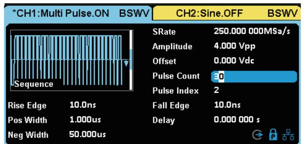
支持最大设置 30 个脉冲，每个脉冲可独立设置脉冲沿和正负脉宽
