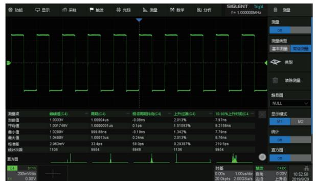
参数统计功能可显示任意参数的五种测量值：当前值、平均值、最小值、最大值、标准差；可同时测量统计 12 种不同的参数。直方图统计可以直观地显示参数的概率分布情况；趋势图可反应参数随时间的变化规律。此外，对水平方向上的测量（如周期、脉宽等），摒弃了传统的一帧只获得一个测量值的方法，将一帧中的所有指定水平项目的测量值都计算出来并纳入统计，大大提高了测试效率
