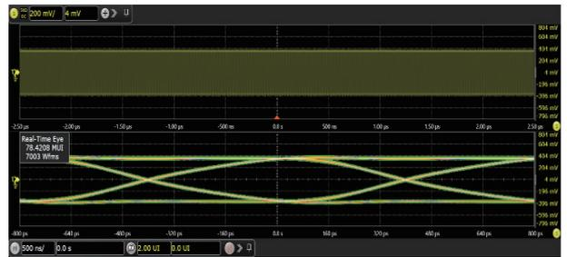
SDG8000A 支持低抖动 1.25 Gbps 的高速串行码型输出，可模拟高速串行数字通信测试。
