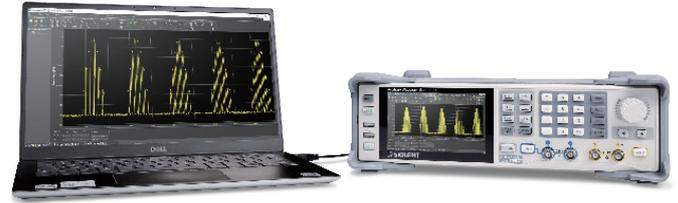
EasyWaveX：任意波形编辑软件 EasyWaveX 提供功能强大的任意波编辑功能，支持手动、直线、坐标、方程式绘图等多种绘图方式，可方便、快捷地生成任意波形。该软件内嵌在 SDG7000A 的系统中，也可以在上位机中安装并通过 USB 或 LAN 接口与 SDG7000A 交互
