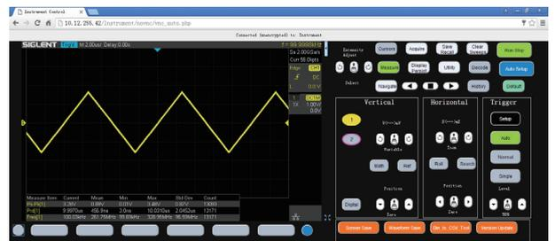
内嵌 Web Server，无需安装驱动软件和上位机软件，通过浏览器即可对仪器进行远程控制、观察波形、获取测量结果，可满足高压、高温等特殊环境的应用需求。内嵌的虚拟控制面板和示波器面板完全相同，使用起来更加简单方便。SDS2000X-E 支持 PC 和手机两种风格的网页布局，在手机上也能轻松完成控制和观察。
