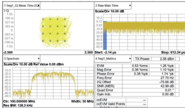
SDG3000X 支持基带或中频 IQ 信号，可生成常用的 ASK, FSK, PSK, QAM 等调制类型的 IQ 信号。SDG3000X 可以在 250 Symb/s ~ 50 MSymb/s 范围内的任意符号率下获得优异的 EVM 性能。内建的数字正交调制器可将 IQ 信号的载波调制到 200 MHz 范围内的任意频点
