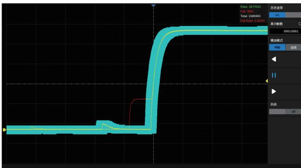
基于硬件的模板测试功能，最高每秒可执行 80000 次测试。根据用户自定义的垂直和水平容限生成模板，比较被测信号是否触碰模板，如果被测信号触碰模板则测试失败，可以预先设定测试失败时采集停止以及蜂鸣器告警，将失败帧自动截图或存入历史帧，适用于长期无人值守监测异常信号
