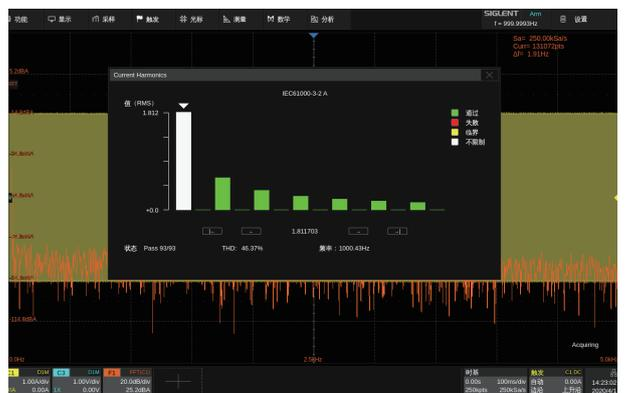
电源分析选件能帮助用户快捷测量和分析电力电子领域中的多个项目，如电源质量，谐波，浪涌电流，开关损耗，输出纹波，瞬变响应，电源抑制比，功率效率等
