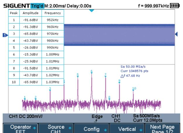
使用专门的协处理器实现高达 1M 点的 FFT, 在获得极高的频谱分辨率的同时, 还能大大加快频谱的刷新速度; 支持多种窗函数, 以适配不同的频谱测量需求。支持 Peaks、Markers、FFT 点数可选。
