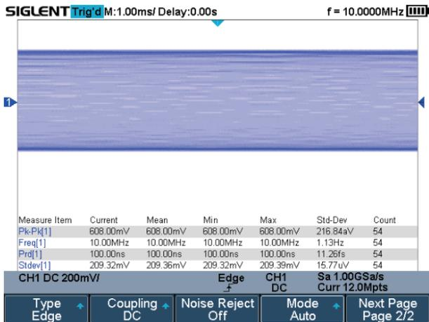
在任一时刻下，SHS800X/SHS1000X 能对所有的原始采样点完成测量，保证测量精度和采样率的完全同步，可满足高采样率、大存储深度、高精度测量的多重需求。在最大存储深度 12M 的情况下，同样具备极快的运算速度，充分保证了大存储深度下的实时测量和统计功能。
