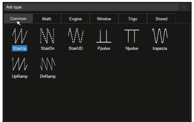
内置 25 MHz 函数 / 任意波形发生器功能，集成了几十种常用内置波形，也可通过从外部导入波形。用户可直接将示波器捕获的波形通过波形发生器还原
