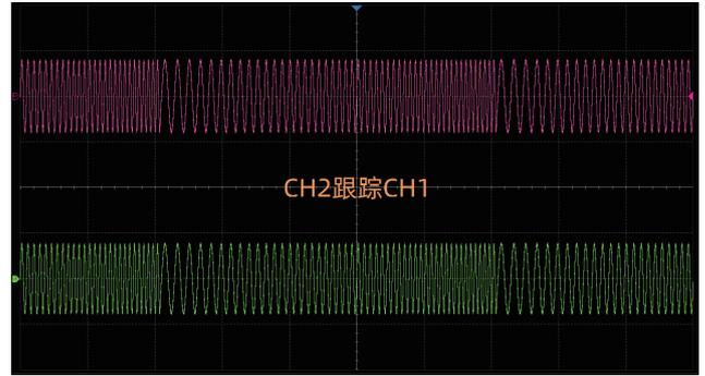
跟踪 / 复制 / 耦合：两个通道间的跟踪、复制和耦合能力，确保一个通道的参数根据需求快速传递到另一个通道，大大简化操作，并满足快速、同步切换波形的需求
