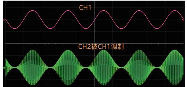
互为调制源：两个通道可互为调制源，为提供复杂的调制波提供了新的手段。作为调制波的通道可同时输出，直接与解调信号进行对比
