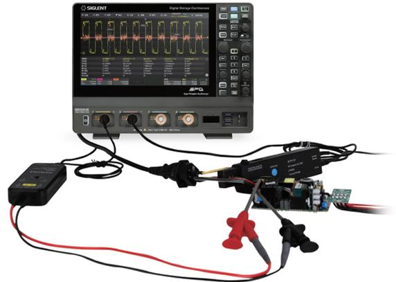
电源分析选件能帮助用户快捷测量和分析电力电子领域中的多个项目,如电源质量,谐波,浪涌电流,开关损耗,输出纹波,瞬变响应,电源抑制比,功率效率等
