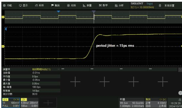
DDS 方法输出方波 / 脉冲时，如果采样率和输出频率不成整数倍关系，将产生一个采样周期的抖动。SDG3000X 采用的 EasyPulse 技术，能够克服 DDS 的这个缺陷，且更高的采样率，产生低抖动的方波 / 脉冲信号
