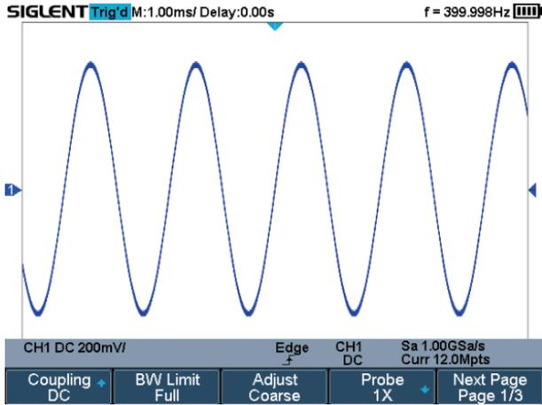
两个通道共用一个 ADC, 低功耗设计, 通道全部打开时, 每个通道采样率 500MSa/s, 保证通道 200MHz 模拟带宽下有足够采样率。
