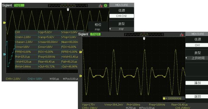
SDS1000A/SDS1000CNL+/SDS1000DL+ 系列产品支持电压、时间和延迟测试种类，共计 32 种参数，用户可根据需求配置 5 组参数显示，也可全部显示 32 种参数的测量结果
