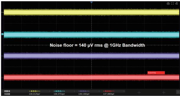
优秀的本底噪声性能，在 1 GHz 全带宽下的底噪值仅为 140 µVrms，让 12-bit ADC 充分发挥性能
