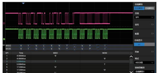
通过事件列表显示解码，能快速、直观地将总线的协议信息以表格形式显示。支持 I2C, SPI, UART, CAN, LIN, CAN FD, FlexRay, I2S 和 MIL-STD-1553B, SENT, Manchester 等多种协议
