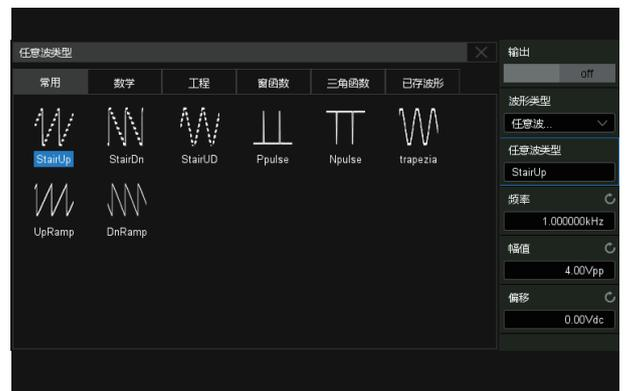
通过 USB Host 接入 25MHz USB 任意波形发生器模块，集成正弦波、方波、三角波、脉冲波、噪声、直流以及 45 种内置任意波，用户也可通过 EasyWave 上位机软件编辑任意波形。
