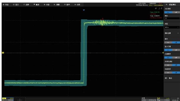
基于硬件的模板测试功能，最高每秒可执行 50000 次测试。根据用户自定义的垂直和水平容限生成模板，比较被测信号是否触碰模板，如果被测信号触碰模板则测试失败，可以预先设定测试失败时采集停止以及蜂鸣器告警，将失败帧自动截图或存入历史帧，适用于长期无人值守监测异常信号
