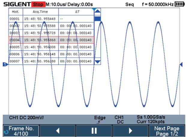
回放历史波形观察异常事件，通过光标或测量参数快速定位问题来源，键盘面板上的“History”按钮可以快速启动该功能。顺序模式将波形存储空间分成多段，每段空间存储一个触发帧，最大可以采集 80,000 个触发事件，在 Sequence 周期内最大限度地降低死区时间（小至 2.5µs），提高对异常事件的捕获概率。Sequence 模式下采集的波形可以通过 History 回放。
