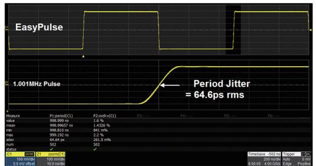
DDS 方法输出方波 / 脉冲时，如果采样率和输出频率不成整数倍关系，将产生一个采样周期的抖动。SDG2000X 采用的 EasyPulse 技术，能够克服 DDS 的这个缺陷，产生低抖动的方波 / 脉冲信号
