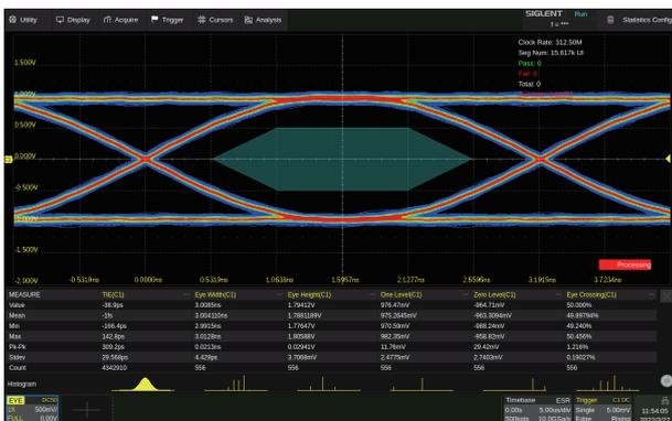
对数字信号进行眼图和抖动分析，自动从串行数据中提取时钟用于重构眼图和进行抖动计算；支持多种眼图和抖动参数的自动测量；支持对眼图的模板测试
