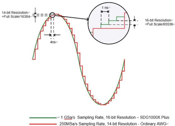
16-bit, 1 GSa/s 的采样系统，在时间和幅度上都具备极高的分辨率，能最大限度地还原波形细节、避免失真
