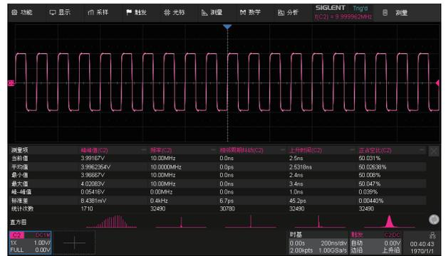
参数统计功能可显示任意参数的五种测量值：当前值、平均值、最小值、最大值、标准差；最多可同时测量统计 12 种不同的参数。直方图统计可以直观地显示参数的概率分布情况；趋势图和轨迹图可反应参数随时间的变化规律。此外，对水平方向上的测量（如周期、脉宽等），摒弃了传统的一帧只获得一个测量值的方法，将一帧中的所有指定水平项目的测量值都计算出来并纳入统计，大大提高了测试效率
