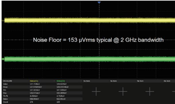
优秀的本底噪声性能，在 2 GHz 全带宽下的底噪值仅为 153  $\mu$ Vrms；在 1 GHz 带宽下仅为 125  $\mu$ Vrms，让 12-bit ADC 充分发挥性能
