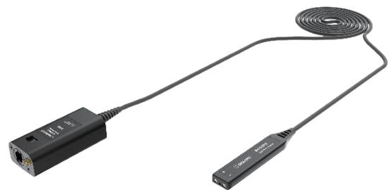
SAP5000D 系列有源差分探头，带宽 5 GHz，上升时间 80 ps，差分输入电容 400 fF，衰减比 10:1，可搭配 SDS7000A 使用
