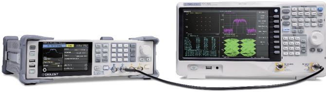
可生成常用的 ASK, FSK, PSK, QAM 等调制类型的 IQ 信号。采用创新的重采样技术, 可以在 250 Symb/s ~ 500 MSymb/s 范围内的任意符号率下获得优异的 EVM 性能。内建的数字正交调制器可将 IQ 信号的载波调制到 1 GHz 范围内的任意频段; 可使用上位机软件 EasyIQ 来生成各种类型的 IQ 信号
