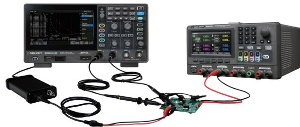
搭配隔离信号发生器选件 (SAG1021I) 或 SDG 任意波形发生器即可进行环路响应测试，提供被测设备 (DUT) 的频率响应曲线，轻松获得各个频率点下的增益和相位值
