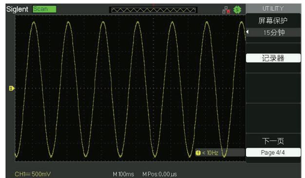
数字记录仪功能可实时、无死区的记录波形数据，支持记录后的波形数据回放功能，适合观测慢速信号的一致性问题。仪器内置 7 Mpts 的数据存储空间，可通过外部 U 盘等存储器扩展
