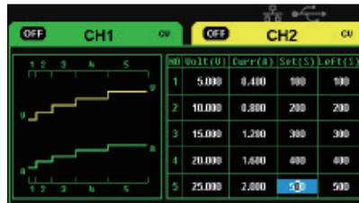
可实现 5 组定时设置和输出控制，可与上位机软件相配合，满足通信和控制需求
