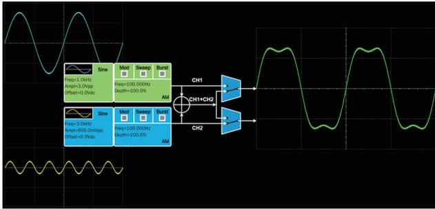
双通道合并：能够将两通道波形合并后输出，具备实时性好、可叠加真正的噪声、可叠加调制信号、扫频信号、Burst 信号、EasyPulse 波形和 TrueArb 波形的优点，为用户提供了精确生成复杂波形的新手段
