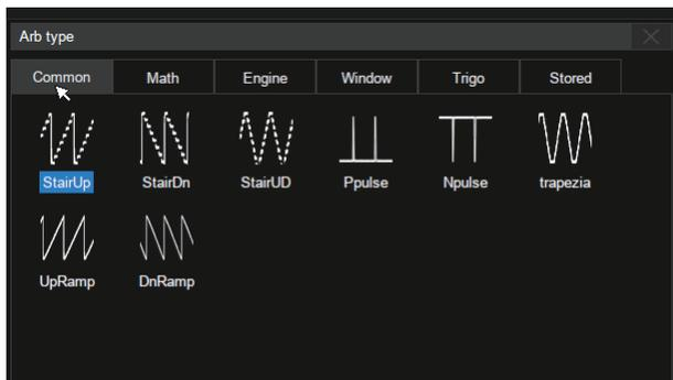
50 MHz 函数 / 任意波形发生器功能，集成了几十种常用内置波形，也可通过从外部导入波形。用户可直接将示波器捕获的波形通过波形发生器还原
