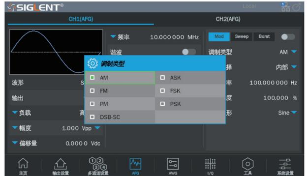
丰富的调制功能，支持常用的 AM / DSB-SC / FM / PM / ASK / FSK / PSK / PWM 调制方式。可选“内部”和“外部”两种调制源。
