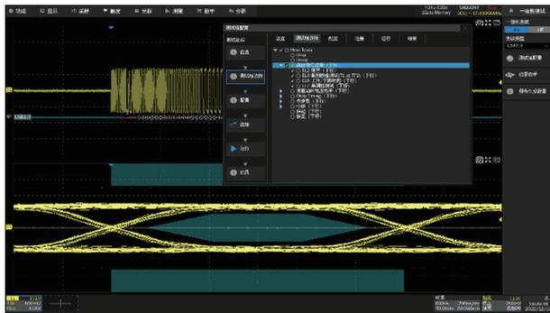
支持 USB2.0、100Base-TX、1000Base-T、2.5 G/5 G/10 G Base-T、100Base-T1、1000Base-T1、MIPI-DPHY、DDR2/DDR3 等协议一致性测试。结合相应的测试夹具，只需用户按提示搭建好环境，即可自动设置示波器和相关仪器并调用相应的测量、运算、解码等功能进行测试，帮助用户快速、高效地完成各个测试项目，并自动生成报告
