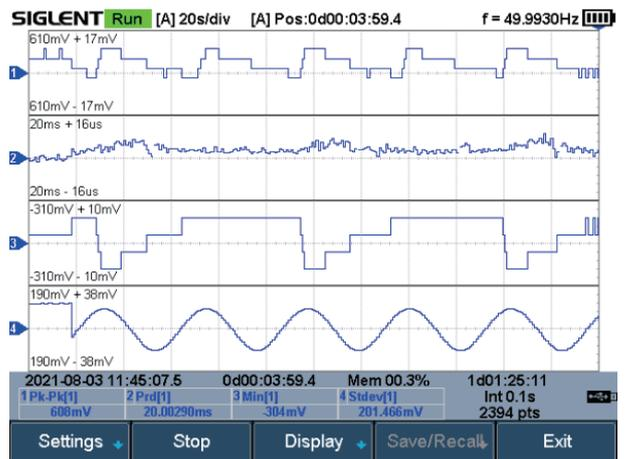
测量值记录仪可以长时间记录测量结果，最多支持 4 组测量值同时记录，记录间隔时间可配置，最小间隔下，记录时长最大可达 100 小时；记录完成后可以将记录结果保存到内部存储器或者 U 盘中。
