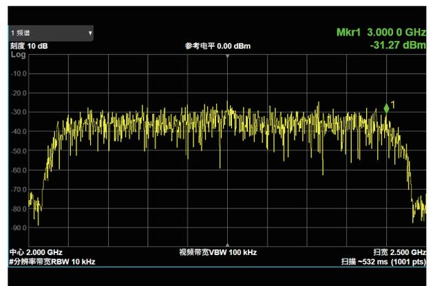
SDG8000A 基带最大数据率 5 GSa/s，采用内部调制器，信号最大调制带宽可达 2 GHz。输出基带信号并采用外部调制器的情况下，可支持 4 GHz 的信号带宽。
