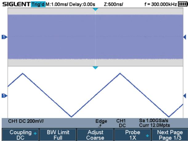
通道交织模式为 12 Mpts/CH, 非交织模式为 6 Mpts/CH。在双通道交织模式下, 用户能够以 1G 的采样率捕获 12ms 长时间的信号, 并结合 Zoom 技术, 放大所关注的区域, 极大提升了用户可细微捕获的时长。
