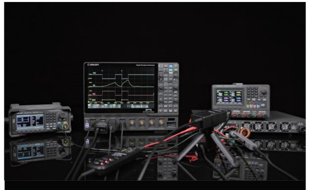
八通道示波器和光隔离探头，补全了宽禁带半导体测试的最后一块拼图。SDS5000L 的上升时间达到了 ps 级别，可以捕捉到碳化硅 (SiC)、氮化镓 (GaN) 的快速变化的波形，分析开关过程中电压，电流的瞬态变化和开关特性。通过观察信号的形状、过冲、振铃等情况，分析信号的完整性，优化电路设计
