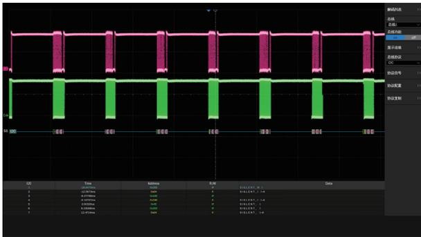
通过事件列表显示解码，能快速、直观地将总线的协议信息以表格形式显示。支持 I2C、SPI、UART、CAN、LIN、CAN FD、CAN XL、FlexRay、I2S、MIL-STD-1553B、SENT、SPMI、ARINC 429、SpaceWire、Manchester、8B/10B 和 USB2.0 等多种协议
