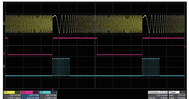
扫频和脉冲串: 扫频支持“线性”和“对数”两种扫频方式, 脉冲串支持“N 循环”和“门控”两种 Burst 方式。扫频和脉冲串都支持“内部”、“外部”和“手动”3 种触发源
