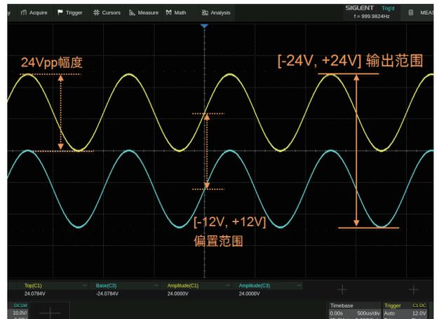
24 Vpp 模拟输出能力叠加  $\pm 12V$  直流偏置, 最大可提供  $\pm 24V$  (48V) 的输出范围
