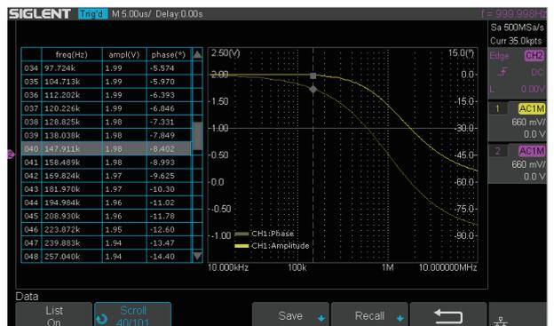
SDS1000X-E 可以控制 USB 任意波形发生器模块或者控制独立的一台 AWG 设备, 执行幅频特性和相频特性扫描, 把结果以波特图或者列表方式展现出来, 并且可以导出扫描数据
