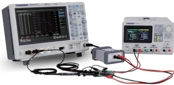
利用波特图测试系统的频率响应或环路稳定性, 在一定领域取代昂贵的网络分析仪。可搭配内置波形发生器或外置 SDG 系列任意波形发生器
