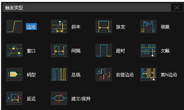
具有丰富的触发功能,包括边沿、斜率、脉宽、视频、窗口、间隔、超时、欠幅、码型、延迟、建立保持和多种总线触发（串行触发）
