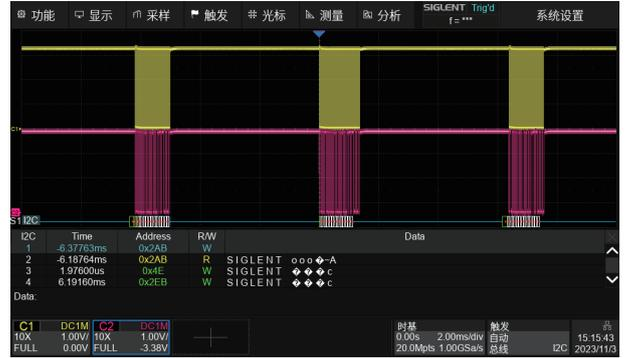
通过事件列表显示解码，能快速、直观地将总线的协议信息以表格形式显示。支持 I2C、SPI、UART、CAN、LIN 多种协议
