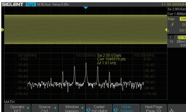
使用专门的协处理器实现高达 1M 点的 FFT，在获得极高的频谱分辨率的同时，还能大大加快频谱的刷新速度；支持多种窗函数以适配不同的频谱测量需求。
