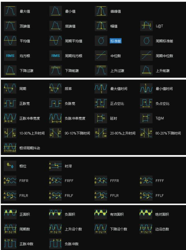
测量类型包括水平类、垂直类、通道间延时类和混合测量类共超过 50 种参数
