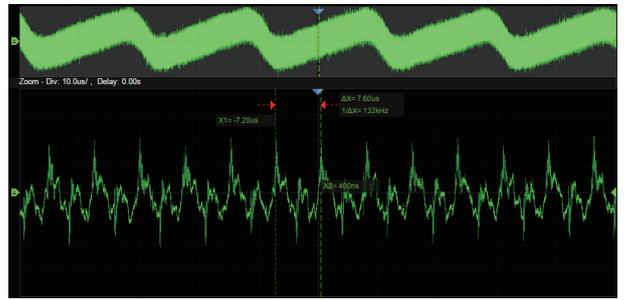
最大 500 Mpts/ 通道的深存储，使用户能够使用更高的采样率捕获更长时间的信号，然后快速放大需要关注的区域，做到整体与细节的兼顾
