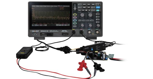
电源分析选件能帮助用户快捷测量和分析电力电子领域中的多个项目，如电源质量，谐波，浪涌电流，开关损耗，输出纹波，瞬变响应，电源抑制比，功率效率等
