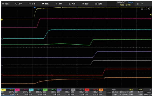
现代电子系统中包含不同的芯片、模块等，不同电路模块的信号在初始化和工作时可能相互影响，通过上电时序测试，可确保各模块信号在正确的时间出现，避免信号冲突、干扰，保证系统正常运行。如在通信系统中，收发模块的上电时序不当，可能造成数据传输错误。随着技术的发展，电路的复杂度不断提高，对上电时序测试也提出了新的挑战。SDS5000L 可一次捕获所有相关信号的上电过程，节省测量时间，提高工作效率，减少因多次测量引入的误差，对有 8 个以上电源轨的复杂电路，可一次完成测量
