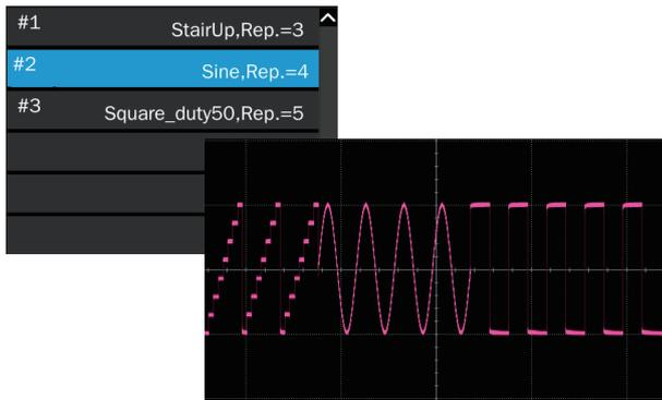
分段编辑和播放：提供把最高 1024 段任意波无缝拼接的能力，每段波形可单独设置重复次数，最高次数 65535 次。这种模式在切换任意波时直接从前一段的最后一个点跳转到后一段的第一个点，不会产生空闲电平，适用于对波形切换要求很高的场合
