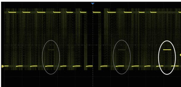
正常模式下 160 000 帧 / 秒，Sequence 模式下 650 000 帧 / 秒的波形刷新率，使示波器能轻松捕获到低概率异常事件
