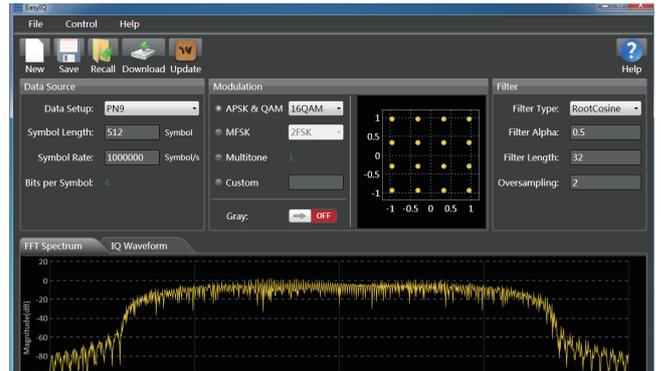
可生成常用的 ASK, FSK, PSK, QAM 等调制类型的 I/Q 信号。创新的重采样技术使得 SDG6000X 可以在 250 Symb/s ~ 37.5 MSymb/s 范围内的任意符号率下获得优异的 EVM 性能。内建的数字正交调制器可将 I/Q 信号的载波调制到 500 MHz 范围内的任意频点
