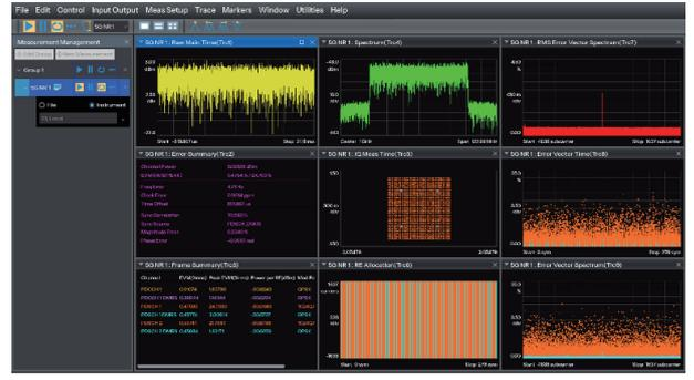
频谱分析模式下, 支持实时频谱仪 (RTSA) 和数字下变频 (DDC) 功能, 并在设备上直接集成信号分析软件 SigVSA, 可以对 DDC 的输出数据直接进行信号分析, 支持的信号类型从简易的 BPSK 到复杂的宽带信号, 如 4G LTE、5G NR、IEEE802.11b/a/g/n/ac/ax/be 和 4096QAM, 并且具有丰富的测量功能
