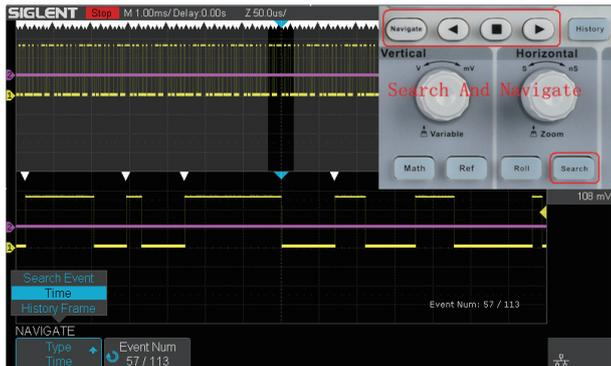
SDS1000X-E 通过指定条件, 对一帧波形进行自动搜索, 并把搜索结果标识出来, 结合导航功能, 快速的定位到感兴趣的事件, 然后结合示波器的分析功能对事件进行详细的分析, 省去了手动搜索的耗时和不便。导航可以对搜索事件导航, 也可以对时间和历史帧导航
