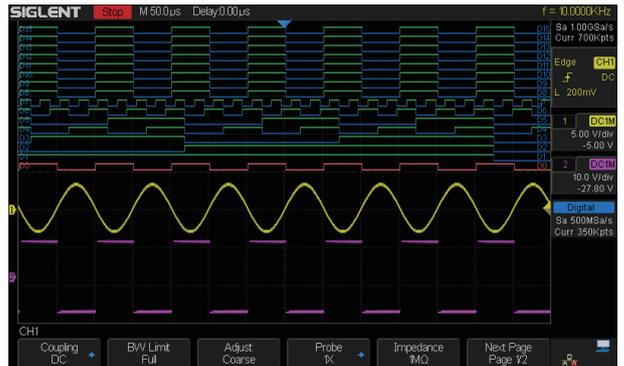
通过外接 16 路逻辑分析仪模块 (SLA1016), SDS1000X-E 支持 MSO 功能, 最高采样率高达 1 GSa/s
