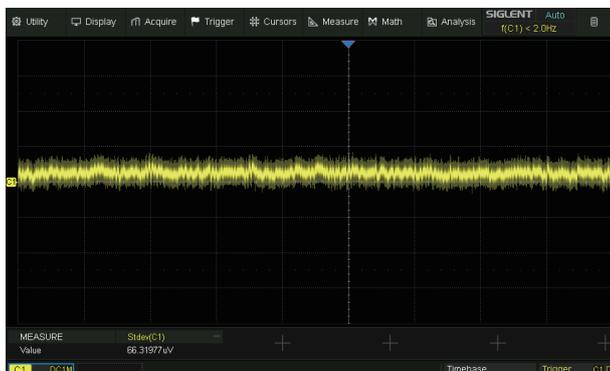
优秀的本底噪声性能，在 200 MHz 全带宽下的底噪声值仅为 70  $\mu$ Vrms，让 12-bit ADC 充分发挥性能
