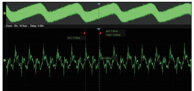
最大 2.5 Gpts / 通道的深存储，使用户能够使用更高的采样率捕获更长时间的信号，然后快速放大需要关注的区域，做到整体与细节的兼顾
