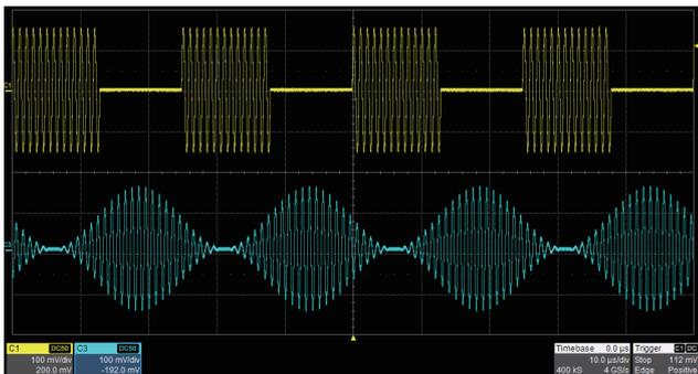
调制: 支持 AM, FM, PM, FSK, ASK, PSK, DSB-AM 和 PWM 等多种模拟和数字调制方式, 有“内部”、“外部”和“通道”三种调制信号源
