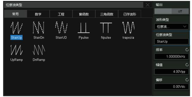
50 MHz 函数 / 任意波形发生器功能, 集成了几十种常用内置波形, 也可通过 EasyWave 上位机软件编辑任意波形并下载。用户可直接将示波器捕获的波形通过波形发生器还原
