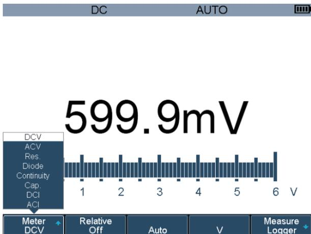
6000 计数的真有效值数字万用表，支持多种不同类型的测量，包含直流电压，直流电流，交流电压，交流电流，电阻，电容，二极管及导通测量。
