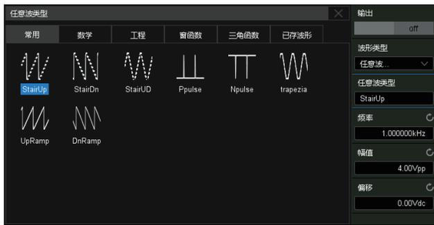
内置 25 MHz 函数 / 任意波形发生器功能，集成了几十种常用内置波形，也可通过从外部导入波形。用户可直接将示波器捕获的波形通过波形发生器还原
