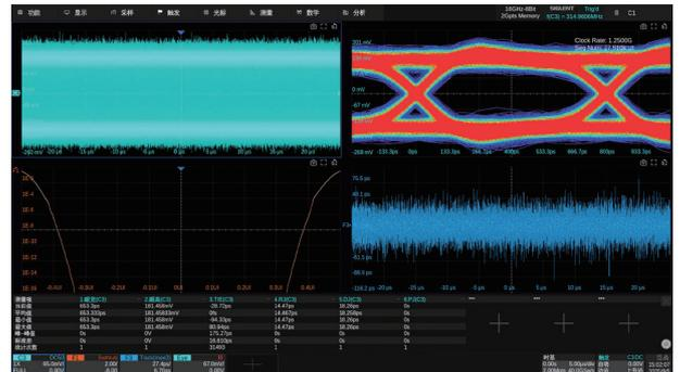
对数字信号进行眼图和抖动分析，自动从串行数据中提取时钟用于重构眼图和进行抖动计算；支持多种眼图和抖动参数的自动测量；支持对眼图的模板测试
