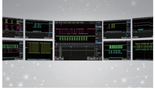
通过事件列表显示解码,能快速、直观地将总线的协议信息以表格形式显示。支持 I2C、SPI、UART、CAN、LIN、CAN FD、FlexRay、I2S、MIL-STD-1553B、SENT 和 Manchester 等多种协议
