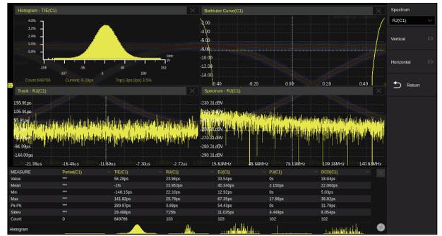
对数字信号进行眼图和抖动分析，自动从串行数据中提取时钟用于重构眼图和进行抖动计算；支持多种眼图和抖动参数的自动测量；支持对眼图的模板测试
