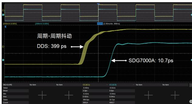
低抖动：DDS 方法输出方波 / 脉冲时，如果采样率和输出频率不成整数倍关系，将产生一个采样周期的抖动。SDG7000A 采用的 EasyPulse 技术，能够克服 DDS 的这个缺陷，将抖动降低一个数量级
