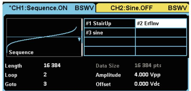
轻松设置各段波形循环次数，以及波形播放顺序；连续、burst、单次三种运行模式；可选“内部”、“外部”、“手动”三种触发源
