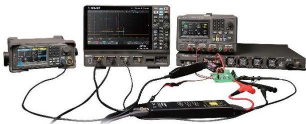
内置双脉冲输出功能，配合鼎阳示波器，无需上位机软件即可快速实现功率器件的开关参数和动态特性测量
