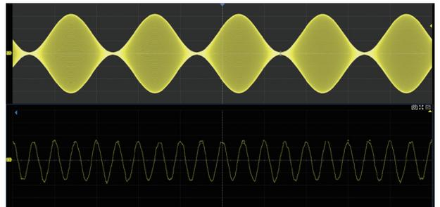
最大 2 Gpts/ 通道的深存储，使用户能够使用更高的采样率捕获更长时间的信号，然后快速放大需要关注的区域，做到整体与细节的兼顾
