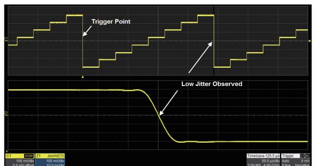
同 EasyPulse 一样，TrueArb 技术有效克服了 DDS 产生一个采样周期抖动的缺陷，能产生低抖动的任意波
