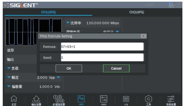
提供 PRBS3 ~ PRBS32 多种码型输出，最高速率可达 120 Mbps，可以输出单端逻辑电平外，差分模式还可轻松将两通道设置成差分对输出。除了采用内置的 PRBS 生成多项式外，还可以自定义 PRBS 生成多项式，使测试更加灵活。
