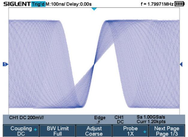
SPO 显示技术是高刷新率和多帧叠加的结果, 在单位时间内, 当某一像素点出现的波形概率越高, 该像素点就越亮, 反之越暗。
