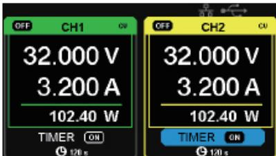
配备 4.3 英寸真彩 TFT-LCD 显示屏，480x272 像素显示，电压、电流连续可调
