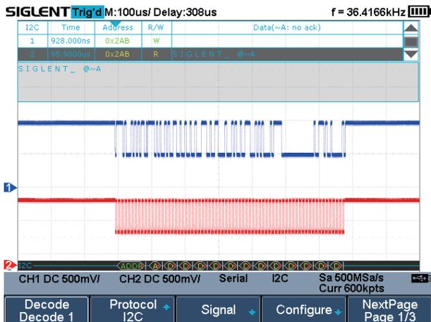
通过事件列表显示解码, 能快速、直观地将总线的协议信息以表格形式显示。
