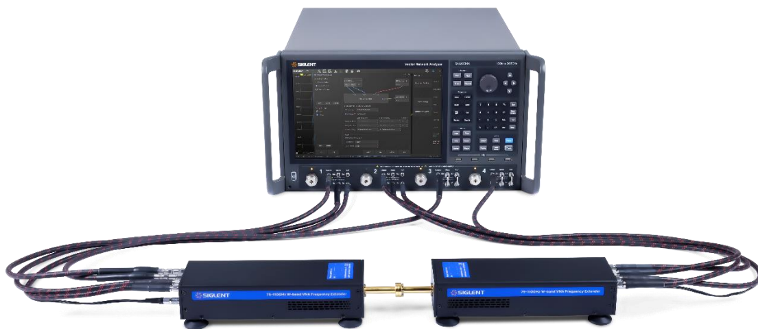
图 1-1 鼎阳科技 VNA 毫米波测量系统
