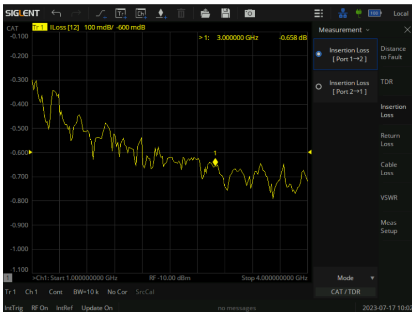
图 13-6 插入损耗测量界面
