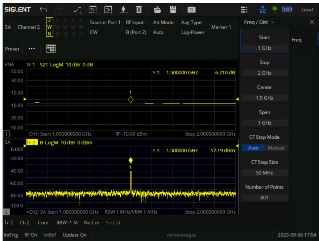
图 11-3 通过按【Freq】键进行 SA 频率相关参数设置
