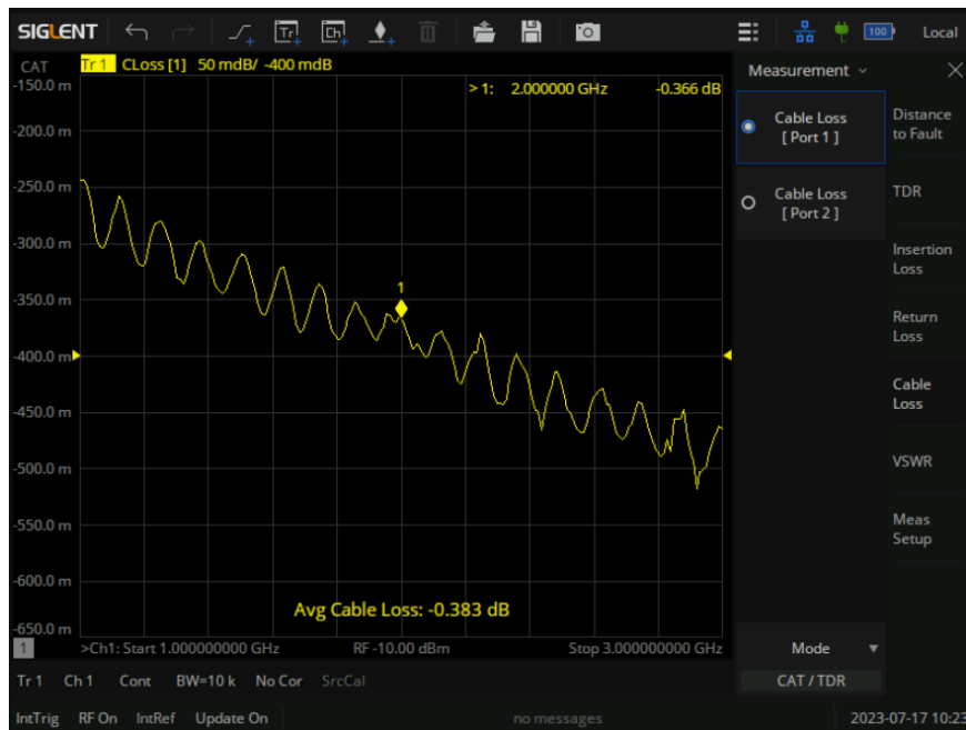
图 13-8 线缆损耗测量界面
