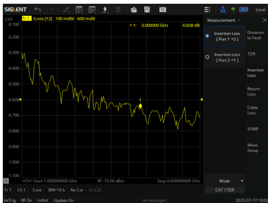
图 13-6 插入损耗测量界面
