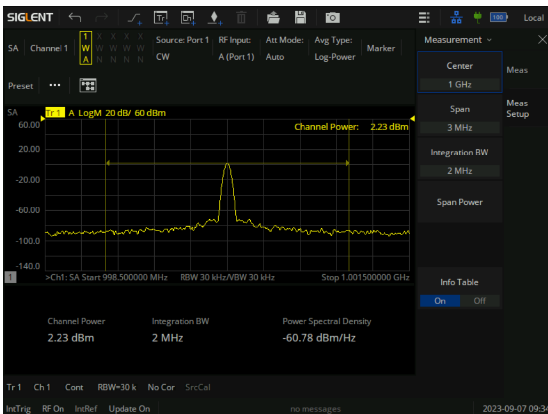
图 11-12 Channel Power 界面
