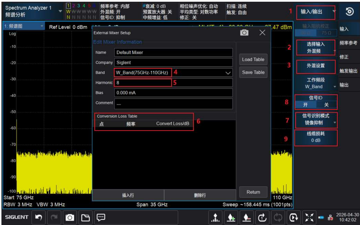
图片 10 频谱仪操作步骤图
