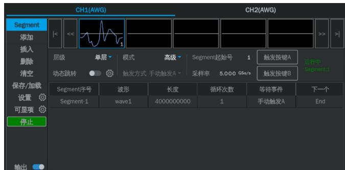
每通道最大4 Gpts 的波形存储空间, 最大采样率下, 可播放800 ms时间的波形, 无需牺牲信号带宽, 满足复杂场景测试需求。
