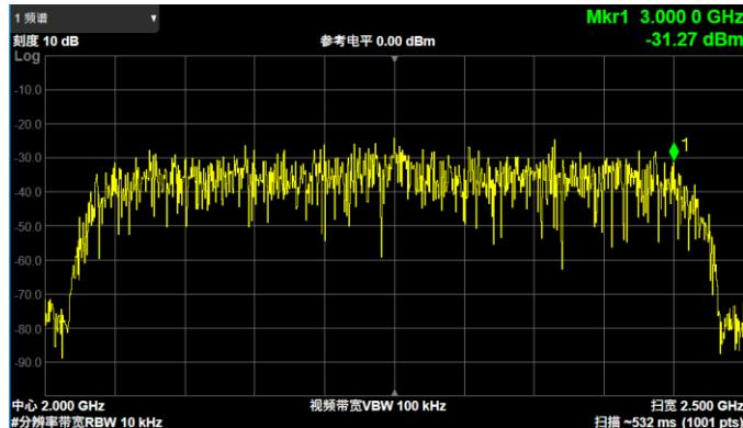
SDG8000A 基带最大数据率 5 GSa/s, 采用内部调制器, 信号最大调制带宽可达2 GHz。输出基带信号并采用外部调制器的情况下, 可支持4 GHz 的信号带宽。
