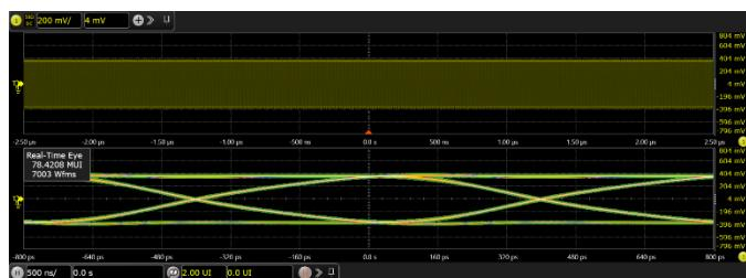
SDG8000A 支持低抖动1.25 Gbps的高速串行码型输出, 可模拟高速串行数字通信测试。
