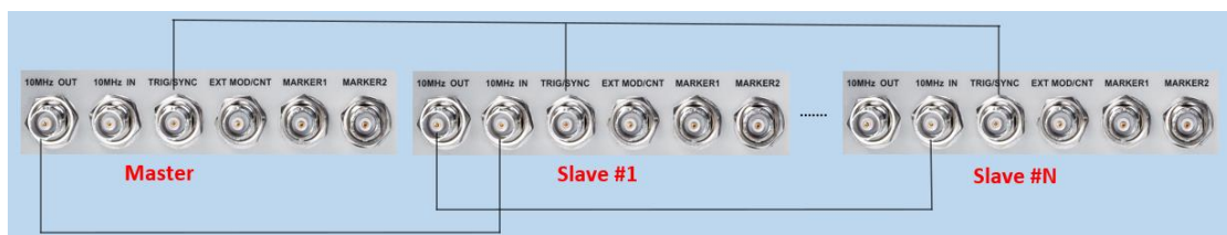
图 17.1 多设备同步的连线示意图
