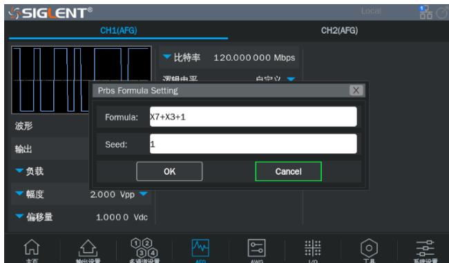
提供 PRBS3 ~ PRBS32 多种码型输出，最高速率可达 120 Mbps，可以输出单端逻辑电平外，差分模式还可轻松将两通道设置成差分对输出。
