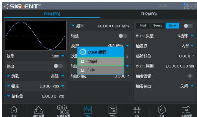
支持“N 循环”和“门控”两种 Burst 方式。
