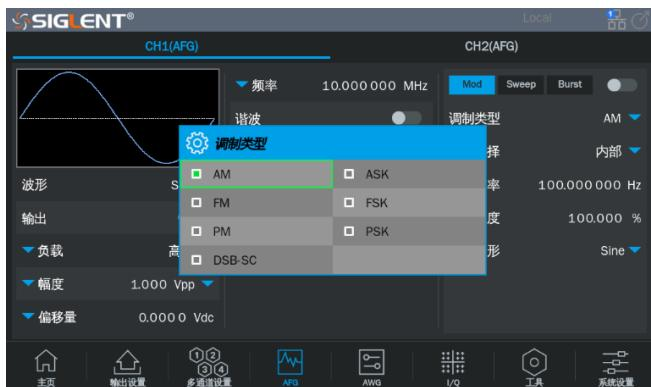
丰富的调制功能，支持常用的 AM / DSB-SC / FM / PM / ASK / FSK / PSK / PWM 调制方式。
