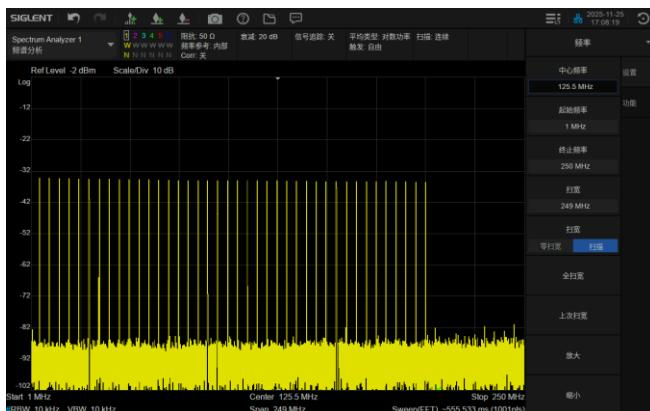
多音功能方便产生多个音调信号，用于音频测试、互调失真以及元件带宽测试。支持最大1024个音调。
