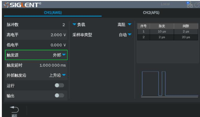
支持最大设置 30 个脉冲，可设置每个脉冲宽度，脉冲间隔。
