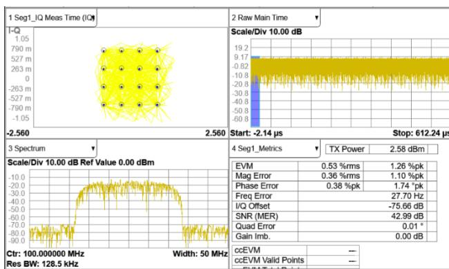
SDG3000X 支持基带或中频 IQ 信号，可生成常用的 ASK，FSK，PSK，QAM 等调制类型的 IQ 信号。SDG3000X 可以在 250 Symb/s ~ 50 MSymb/s 范围内的任意符号率下获得优异的 EVM 性能。内建的数字正交调制器可将 IQ 信号的载波调制到 200 MHz 范围内的任意频点。
