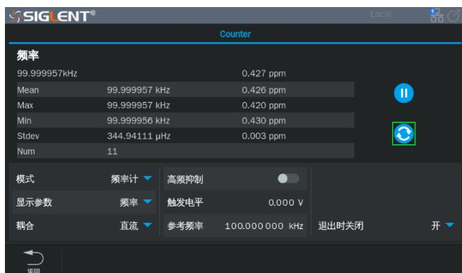
计数器在频率计模式时，可用于测量信号的频率、周期、占空比，测量范围 0.1 Hz ~ 200 MHz。
