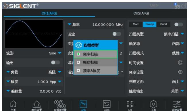
支持频率、幅度、频率和幅度三种 Sweep 模式，轻松实现扫频、扫幅测试。
