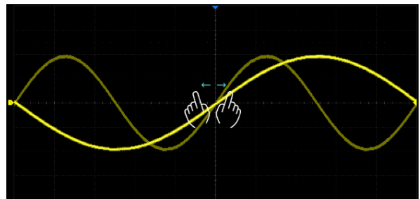
通过水平方向的两点缩放手势控制波形的水平档位
