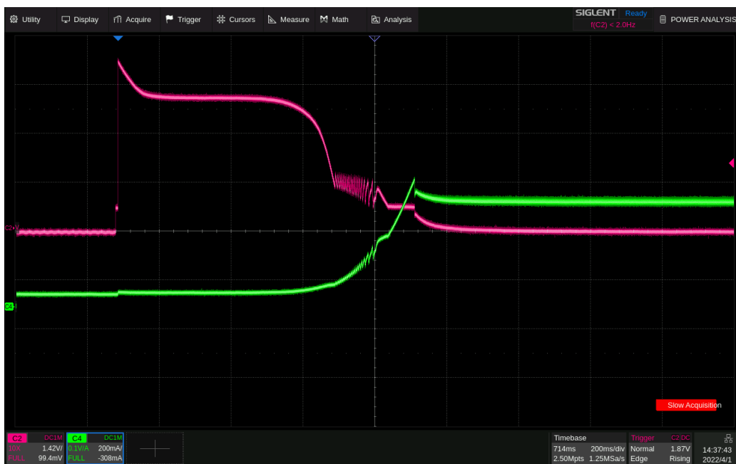
上电时 MOSFET 上的电压和电流波形
