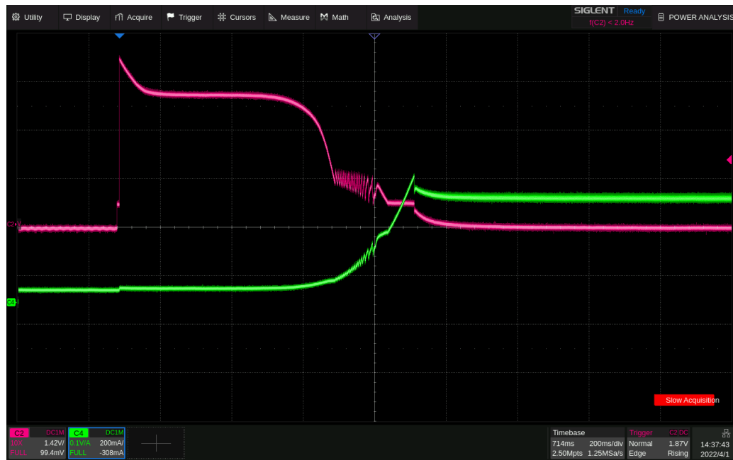
上电时 MOSFET 上的电压和电流波形
