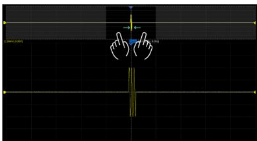
在主波形区的放大区域或 Zoom 波形区通过水平方向的两点缩放手势控制 Zoom 波形区的水平档位
