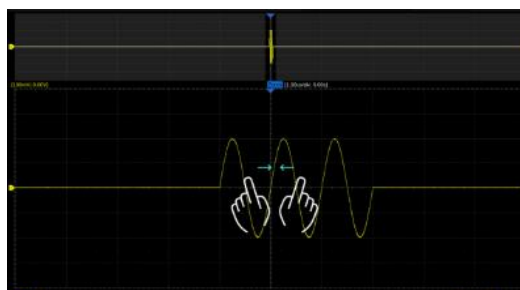
在主波形区的放大区域或 Zoom 波形区通过水平方向的两点缩放手势控制 Zoom 波形区的水平档位
