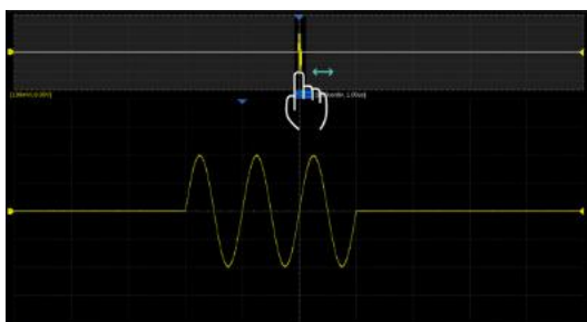
在主波形区的放大区域或 Zoom 波形区左右滑动来控制放大区域的水平位移
