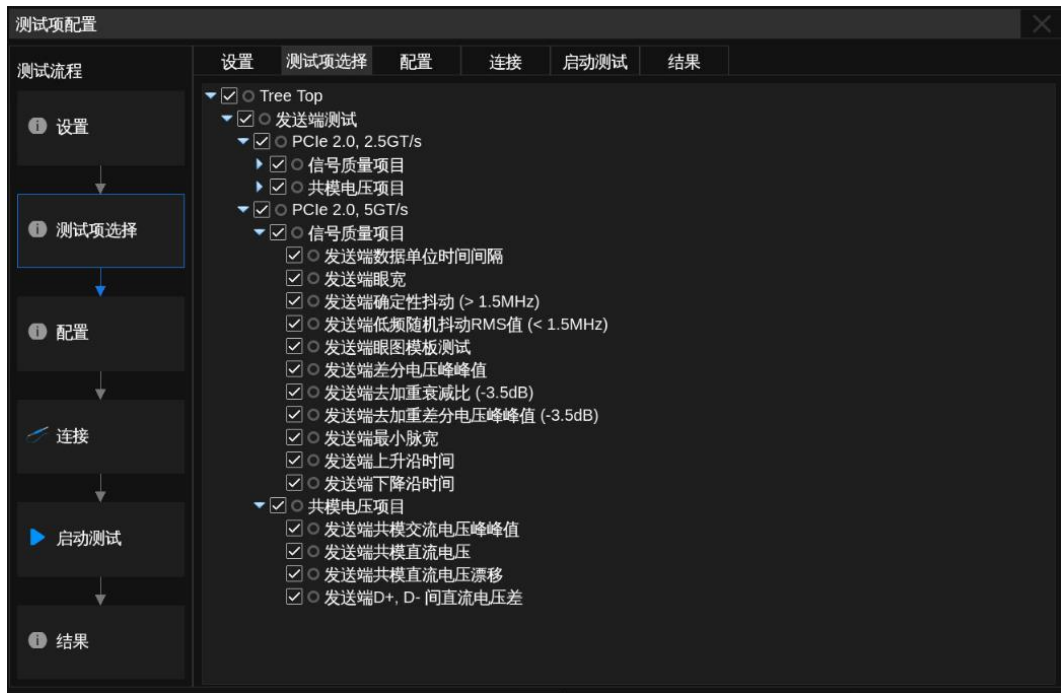
图 5-8 TX 测试 - PCIe 2.0 可用测试项图示
