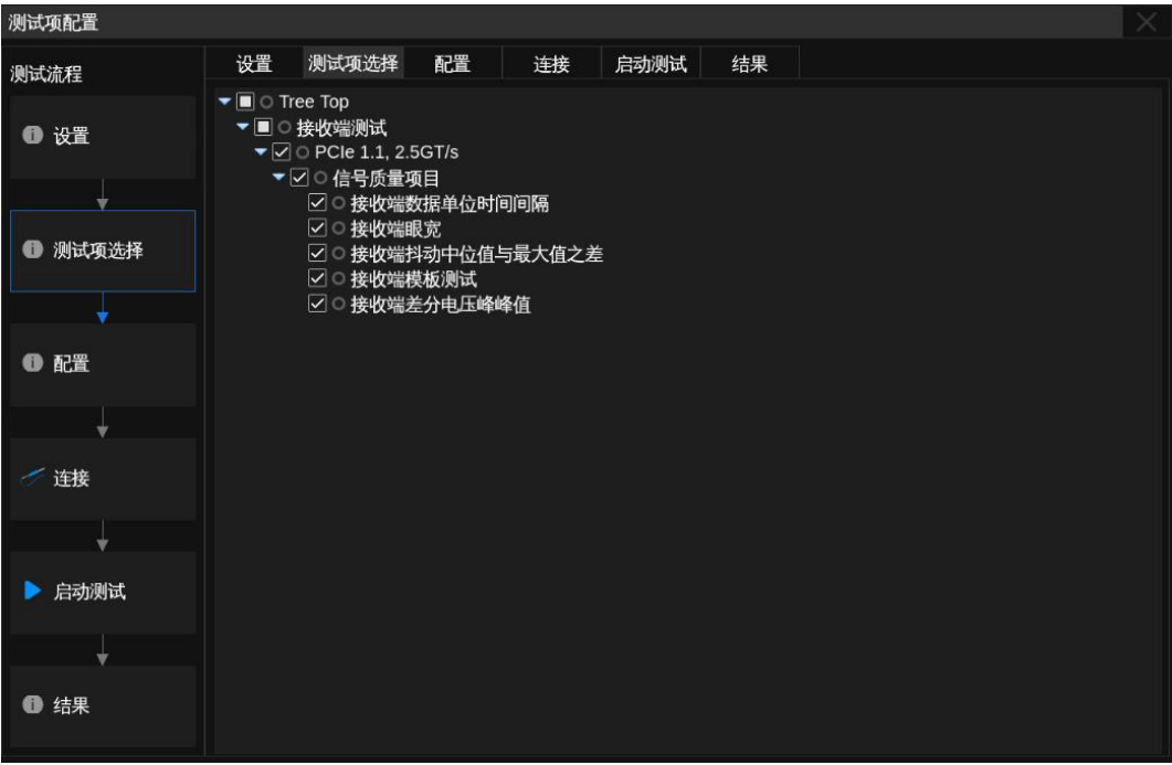
图 5-10 RX 测试 - PCIe 1.0 可用测试项图示
