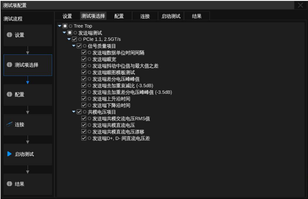
图 5-7 TX 测试 - PCIe 1.0 可用测试项图示
