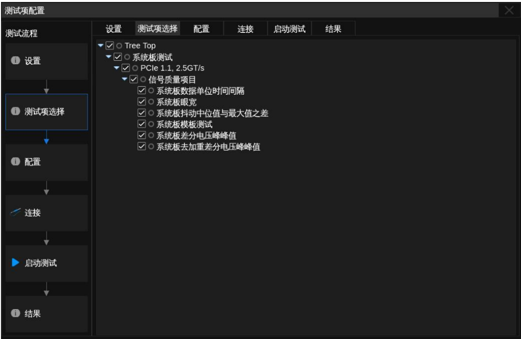
图 5-16 CEM 系统板测试 - PCIe 1.0 可用测试项图示
