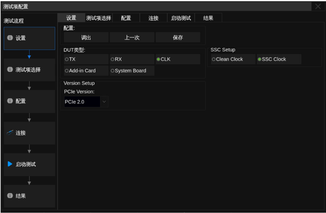
图 5-18 参考时钟测试 - 设置页面图示
