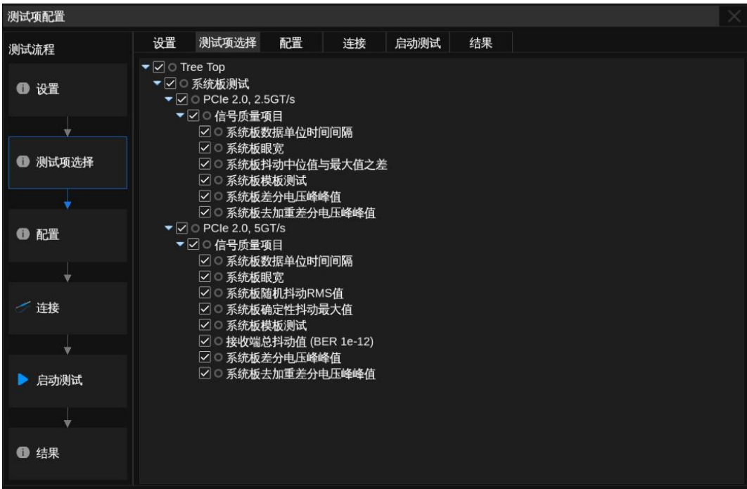
图 5-17 CEM 系统板测试 - PCIe 2.0 可用测试项图示
