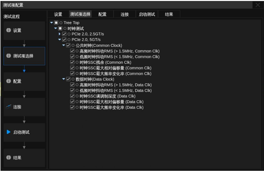
图 5-20 参考时钟测试 - PCIe 2.0 可用测试项图示
