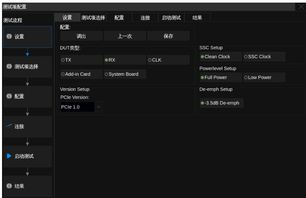
图 5-9 RX 测试 - 设置页面图示
