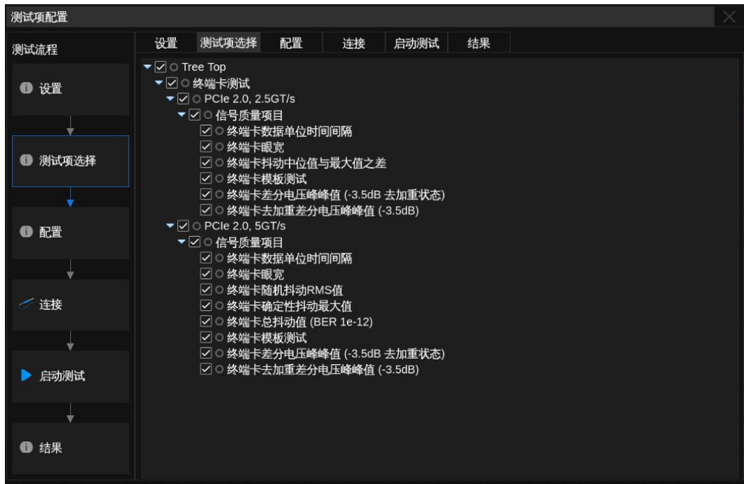
图 5-14 CEM 终端卡测试 - PCIe 2.0 可用测试项图示
