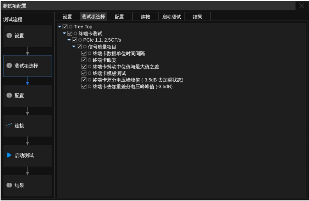
图 5-13 CEM 终端卡测试 - PCIe 1.0 可用测试项图示
