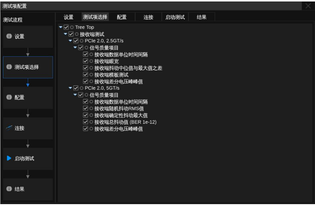
图 5-11 RX 测试 - PCIe 2.0 可用测试项图示
