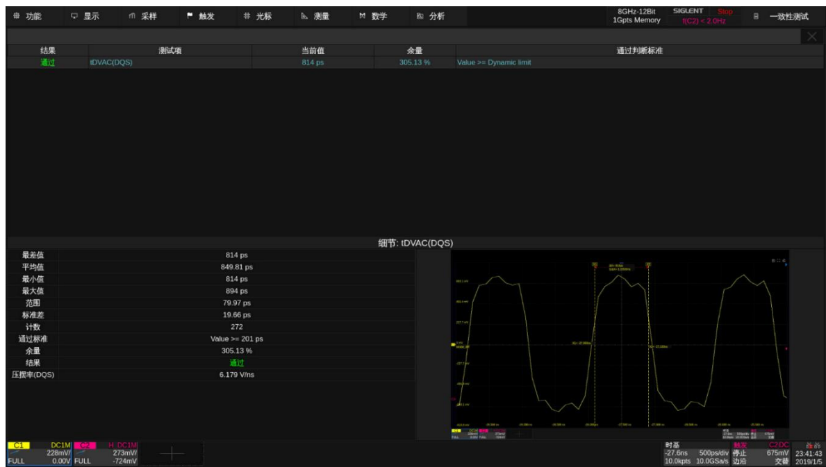
图 10.11-2 DDR3 tDVAC(DQS)测试示例
