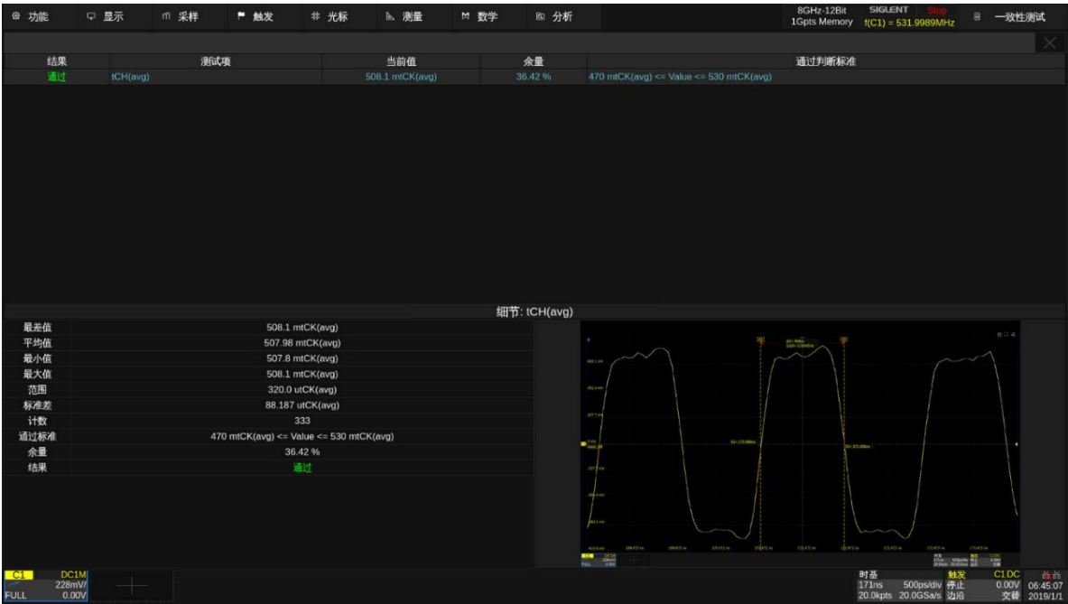
图 7.6-1 DDR3 tCH(avg)测试示例
