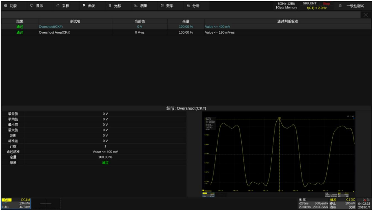
图 6.3-3 DDR3 Overshoot(CK#)和 Overshoot Area(CK#)测试示例
