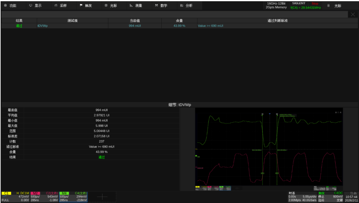
图 11.9-1 DDR4 tDVWp 测试示例
