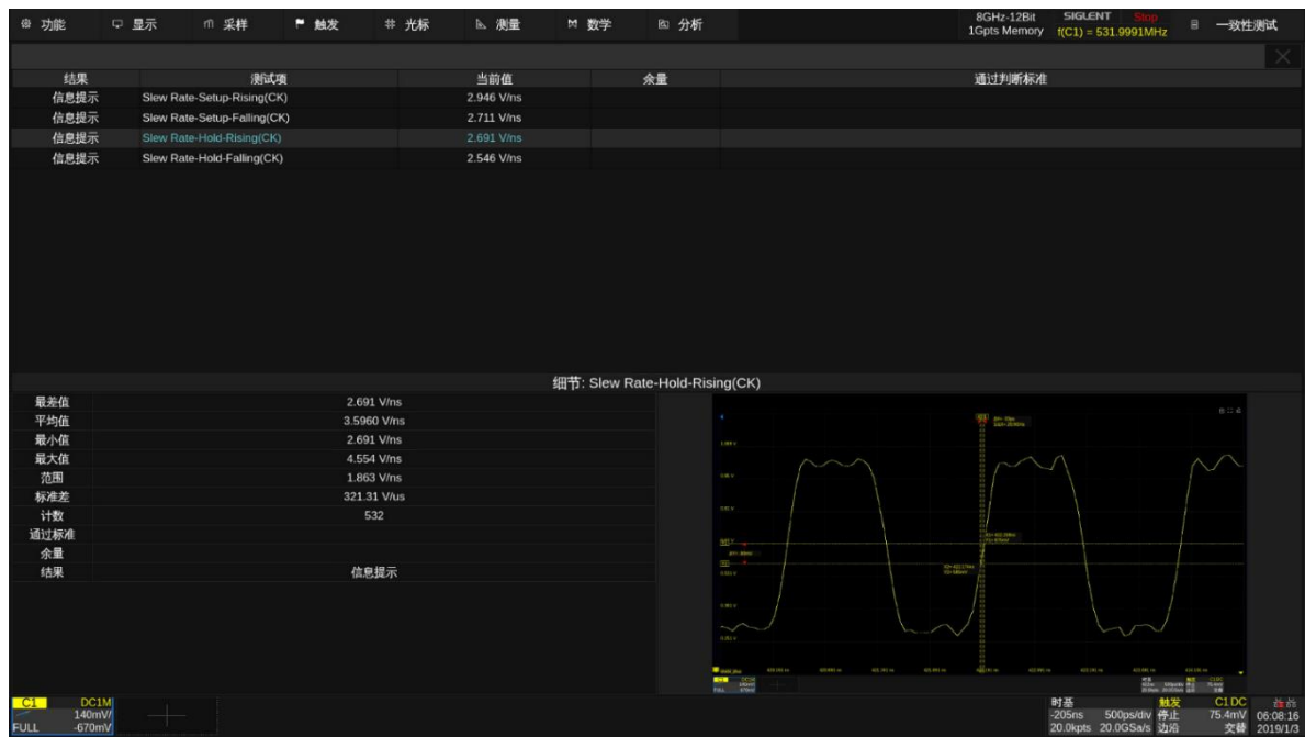
图 5.5-3 DDR3 Slew rate Setup/Hold-Rising/Falling(CLK)测试示例
