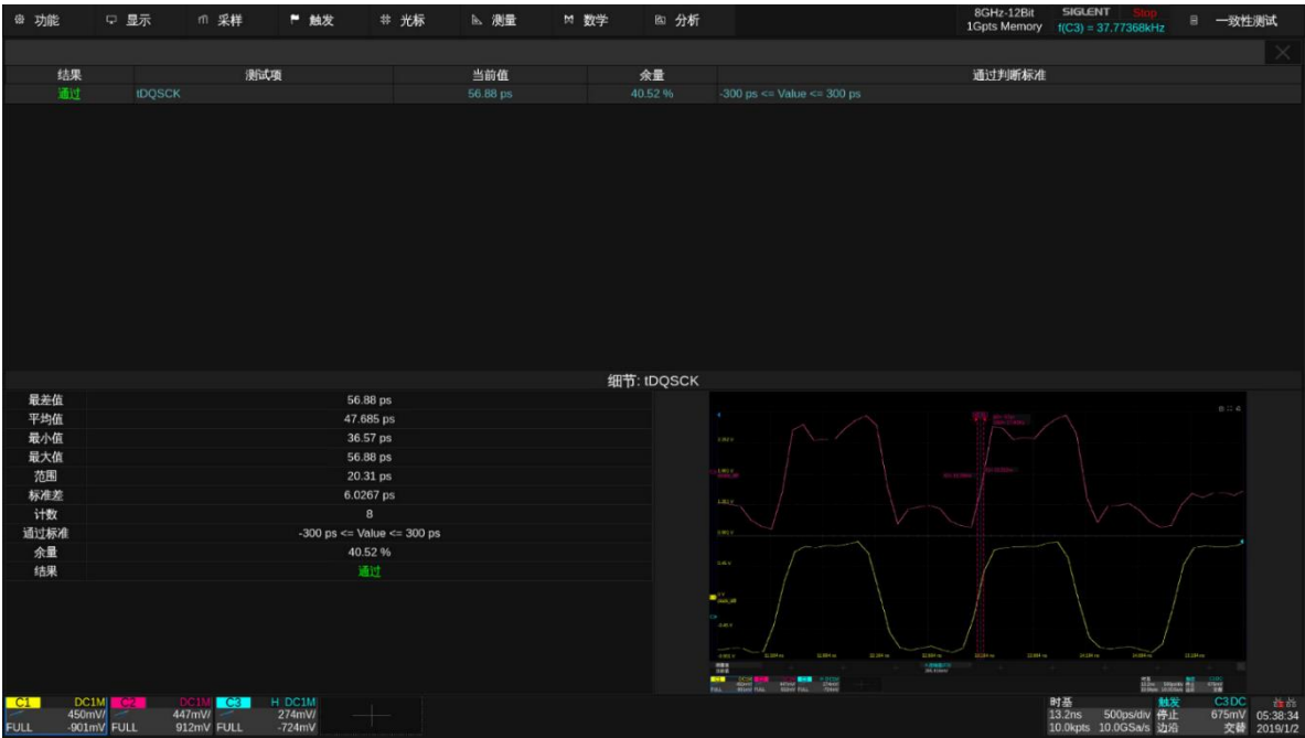
图 10.1-1 DDR3 tDQSK 测试示例
