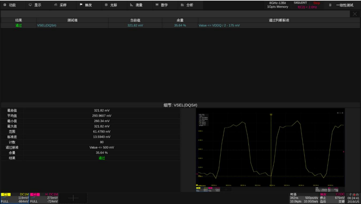
图 9.6-2 VSEL(DQS#)测试示例
