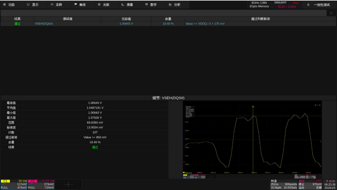
图 9.5-1 VSEH(DQS#)测试示例
