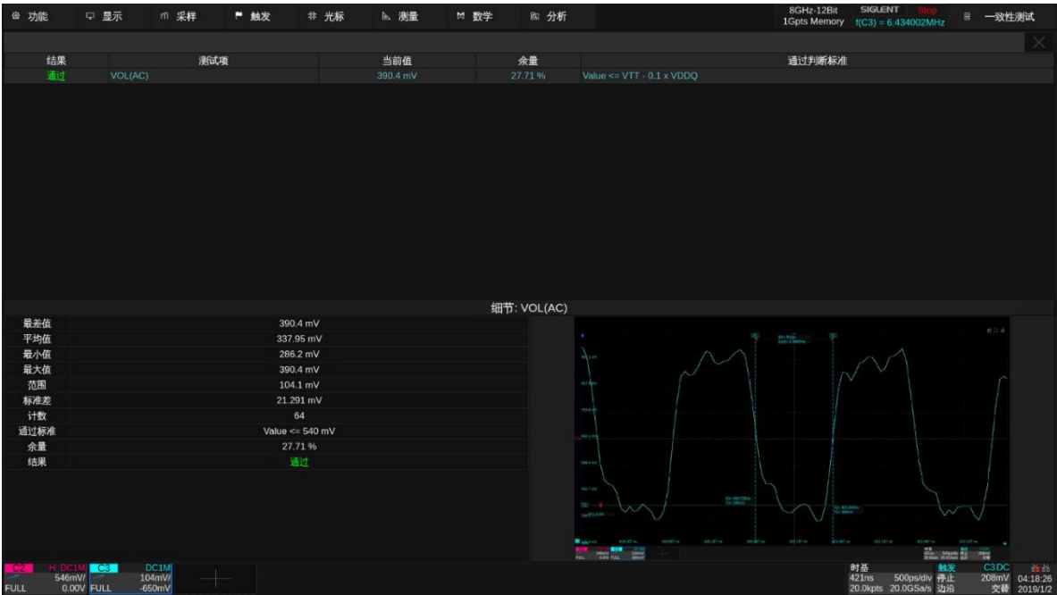
图 11.35-1 DDR3 VOL(AC)测试示例
