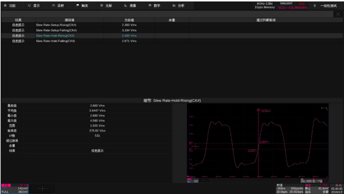
图 6.5-3 DDR3 Slew rate Setup/Hold-Rising/Falling (CK#)测试示例
