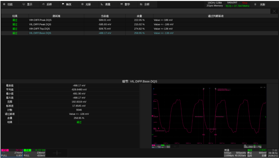
图 10.25-1 DDR4 VIL.Diff.Base.DQS 测试示例
