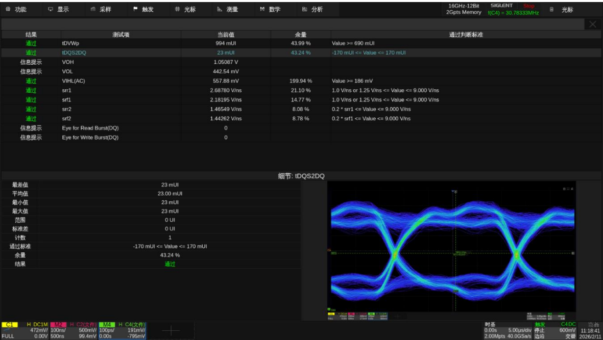
图 11.11-2 DDR4 tDQS2DQ 测试示例
