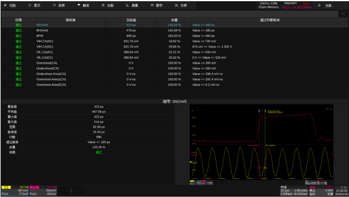
图 13.3-2 DDR4 tIS(Vref)测试示例
