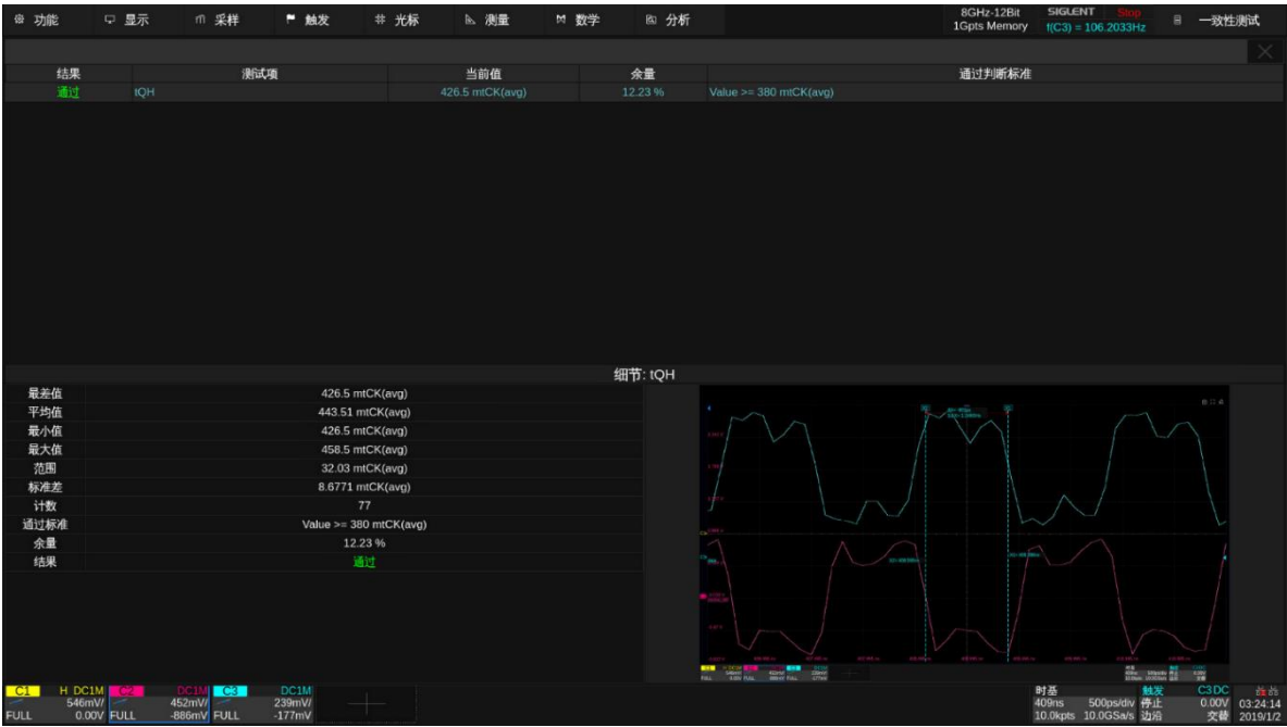
图 11.4-2 DDR3 tQH 测试示例
