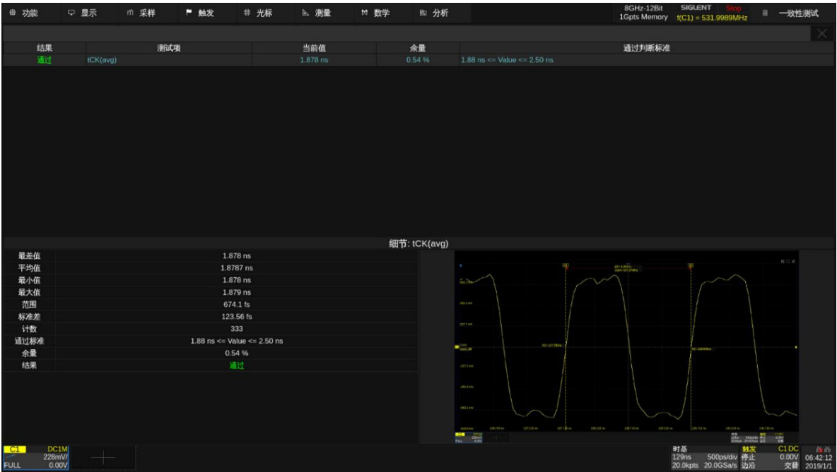
图 7.5-1 DDR3 tCK(avg)测试示例
