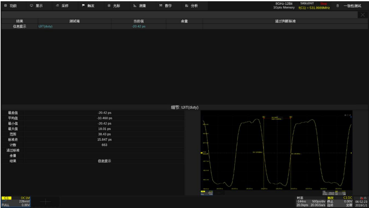
图 7.10-1 DDR3 tJIT(duty)测试示例
