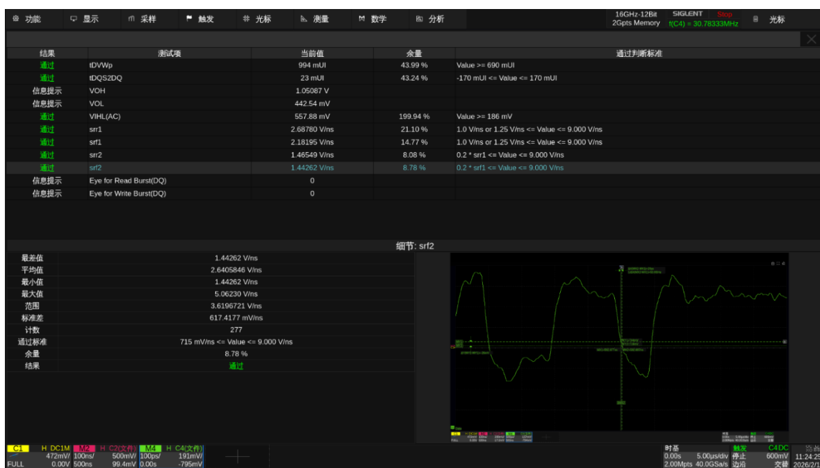
图 11.18-2 DDR4 sr2 测试示例
