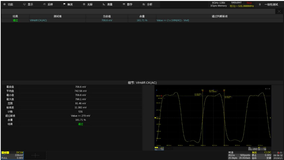
图 7.14-1 DDR3 VIHdiff.CK(AC)测试示例
