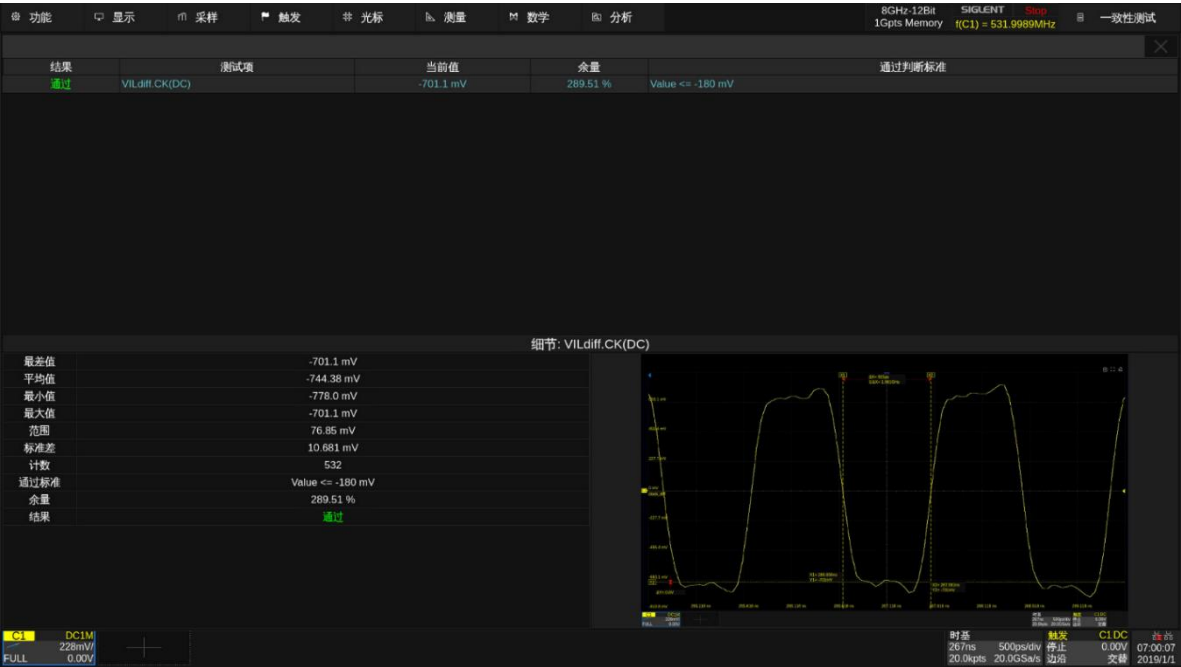
图 7.17-1 DDR3L VILdiff.CK(DC)测试示例
