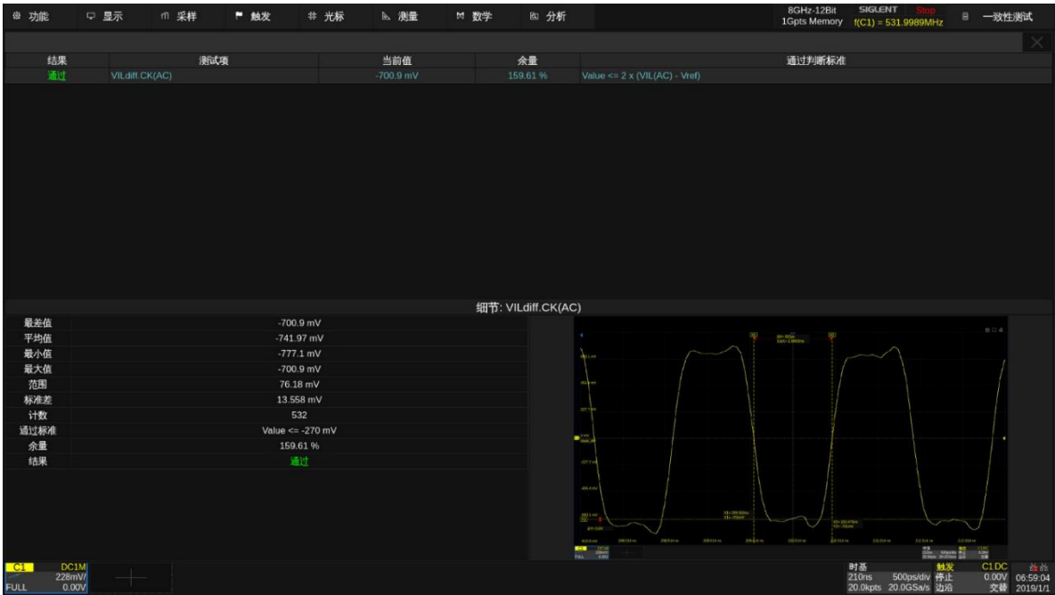
图 7.15-1 DDR3 V ILdiff.CK(AC) 测试示例
