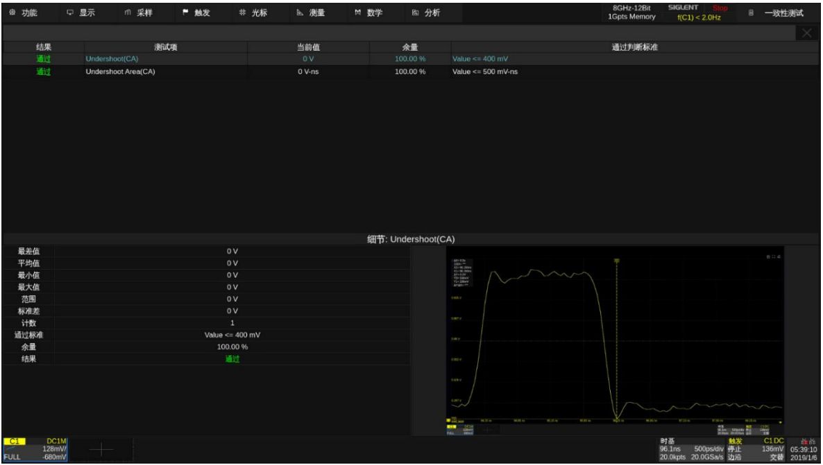
图 13.15-3 DDR3 Undershoot(CA)和 Undershoot Area(CA)测试示例
