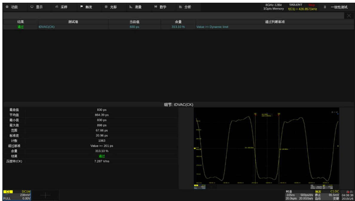
图 7.11-2 DDR3 tDVAC(CK)测试示例
