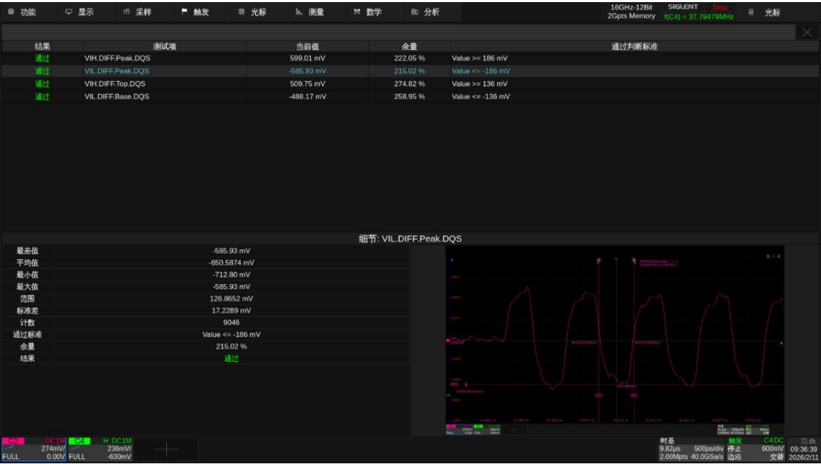
图 10.23-2 DDR4 VIL.Diff.Peak.DQS 测试示例
