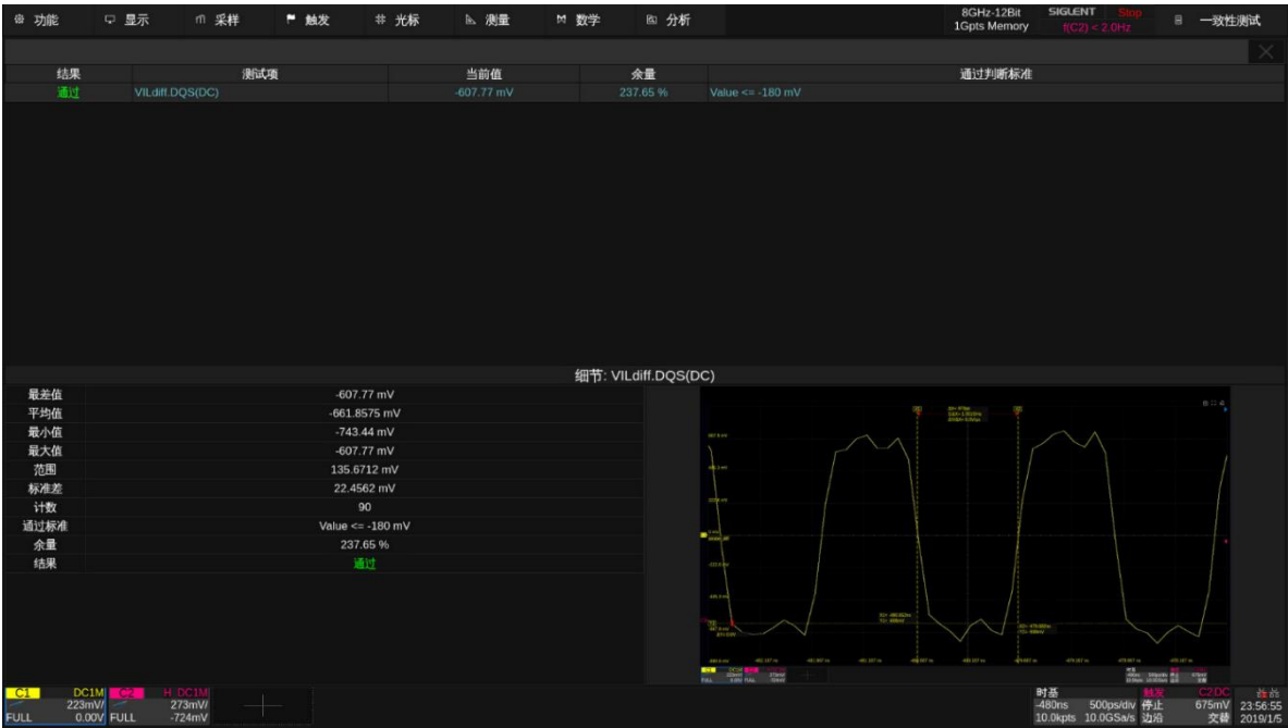
图 10.21-1 DDR3L VILdiff.DQS(DC)测试示例
