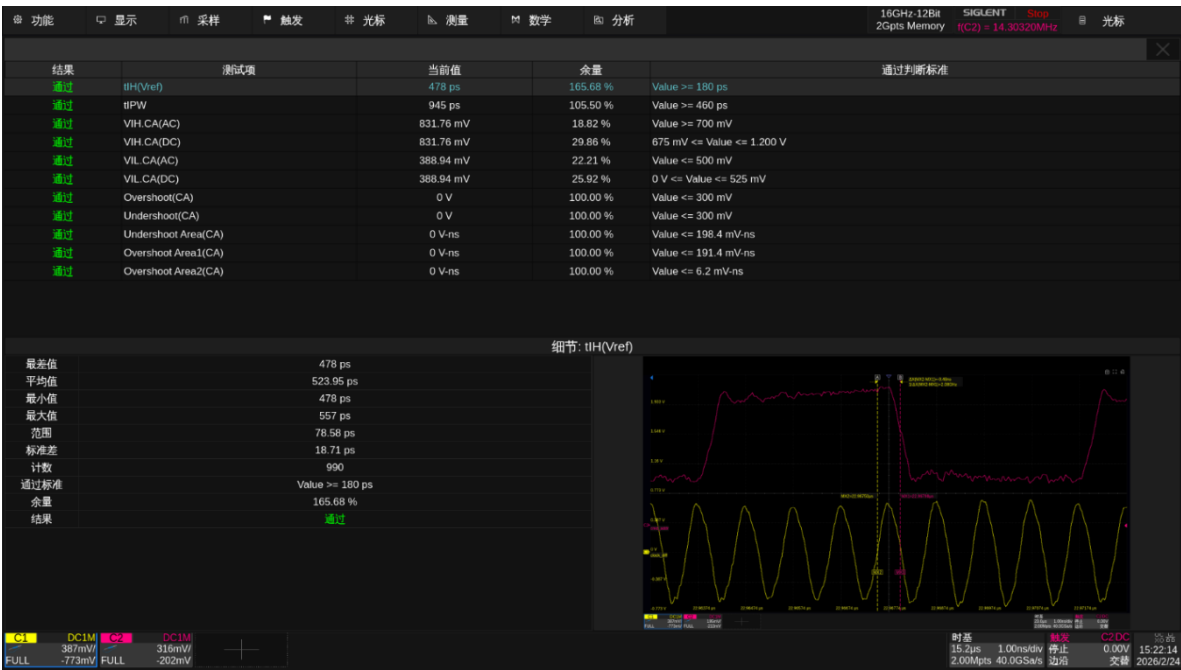
图 13.6-2 DDR4 tIH(Vref)测试示例
