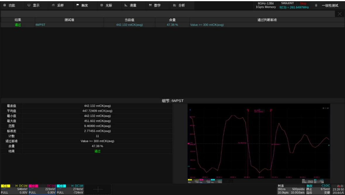
图 10.7-3 DDR3 tWPST 测试示例
