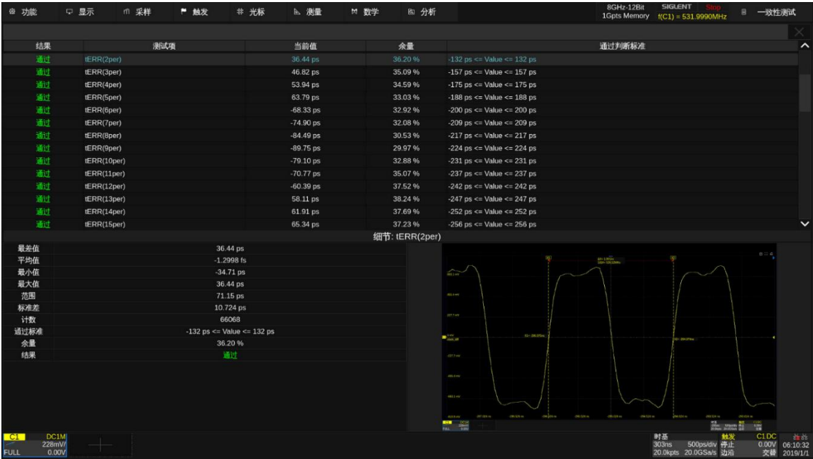
图 7.1-1 DDR3 tERR(CK)测试示例
