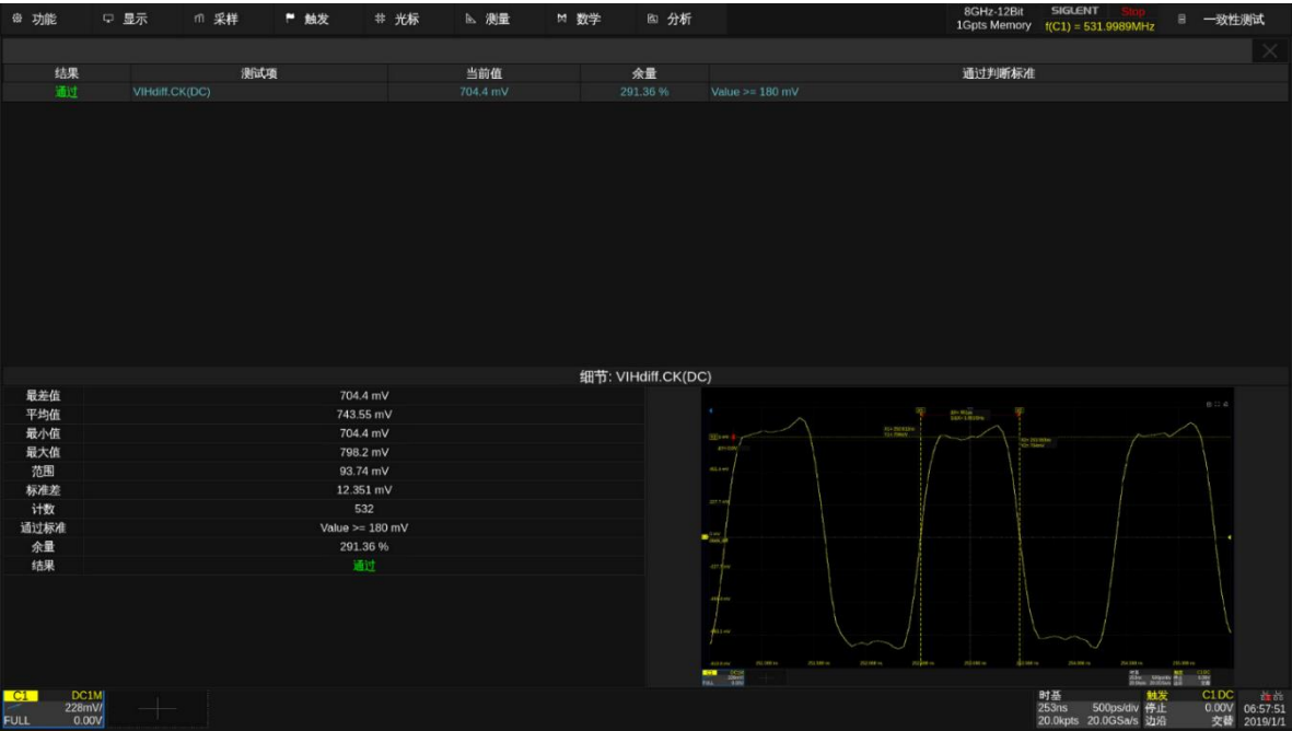
图 7.16-1 DDR3L VIHdiff,CK(DC)测试示例
