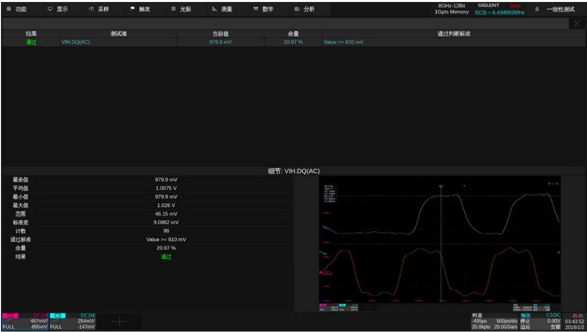
图 11.22-1 DDR3 VIH.DQ(AC)测试示例
