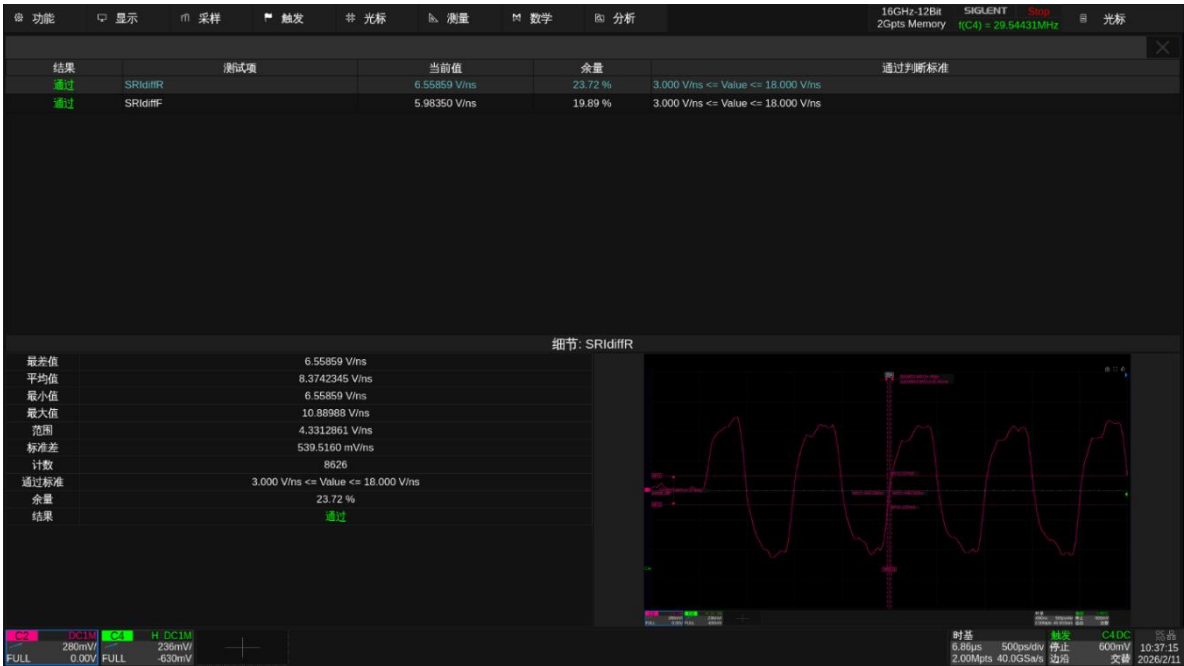
图 10.28-2 DDR4 SRIdiffR 测试示例
