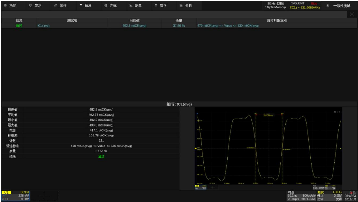
图 7.7-1 DDR3 tCL(avg)测试示例
