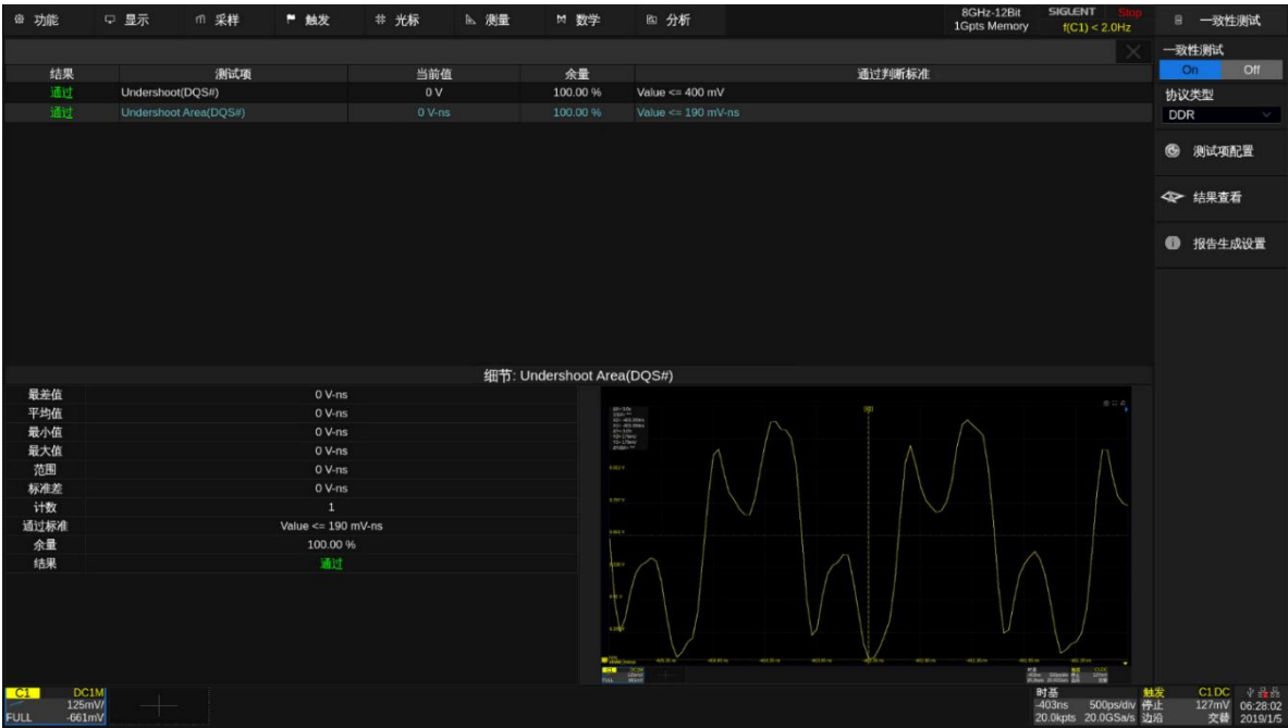
图 9.4-3 DDR3 Undershoot(DQS#)和 Undershoot Area(DQS#)测试示例
