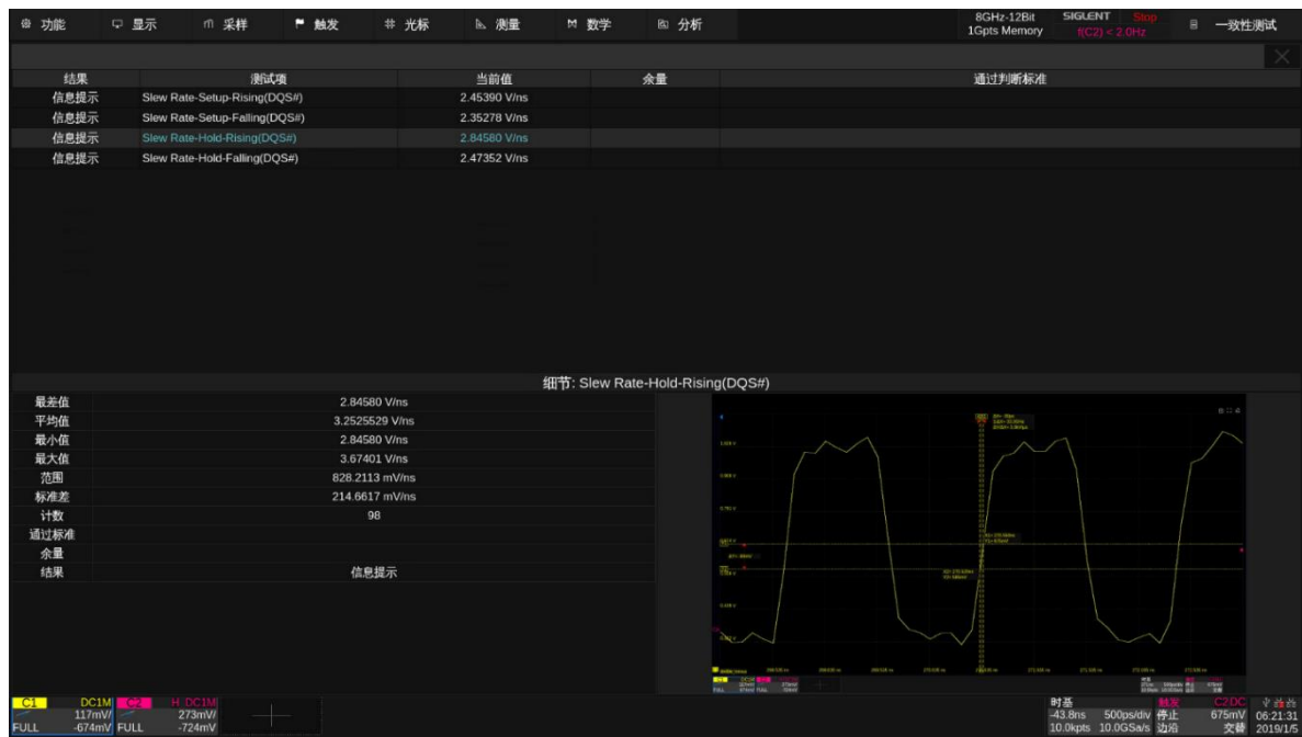
图 9.2-3 DDR3 Slew rate Setup/Hold-Rising/Falling(DQS#)测试示例
