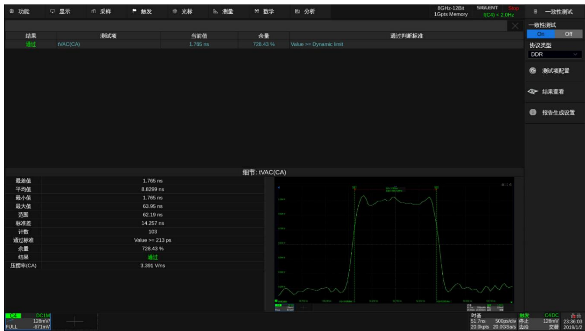
图 13.8-2 DDR3 tVAC(CA)测试示例
