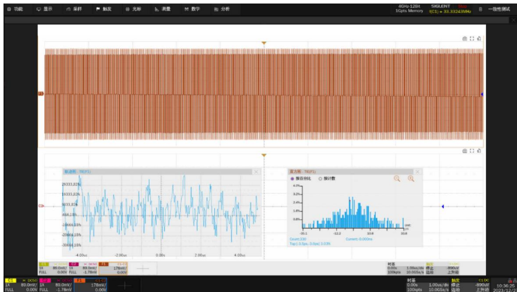
图 6-7 发射时钟频率和发射机时序抖动测试结果波形细节
