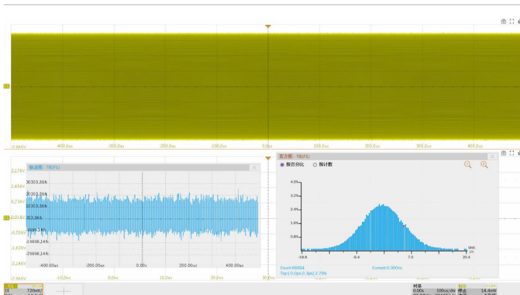
图 6-11 TX_TCLK 时序抖动波形展开细节
