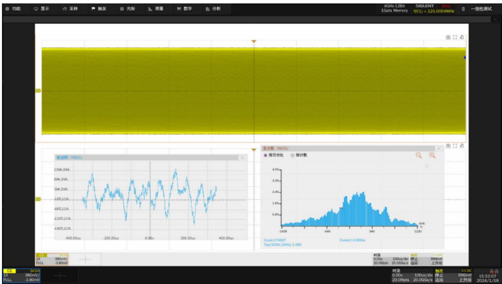
图 7-4 TX_TCLK125 波形细节
