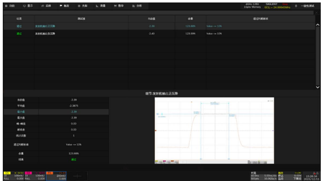
图 7-34 发射机输出正/负压降参考结果
